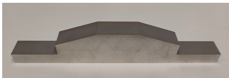
Obrázek 3.4: Kalibrační objekt dodaný výrobcem
