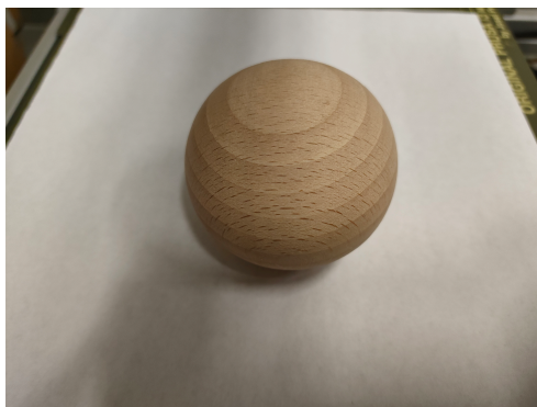
Obrázek 3.2: Dřevěná koule o poloměru 29,5 mm
