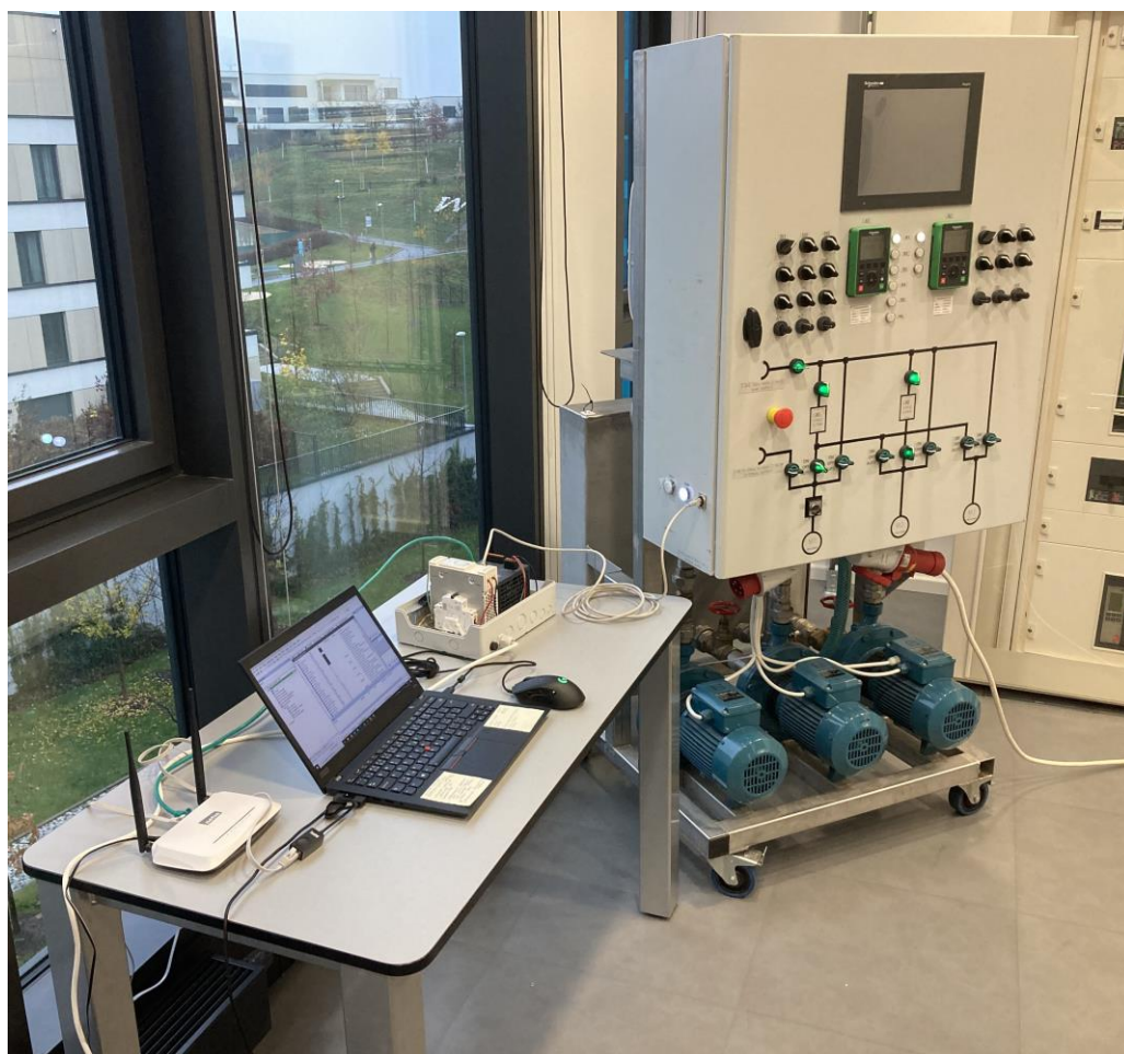
Obr. F-1 Pohled na sestavu didaktického modelu čerpací soustavy
