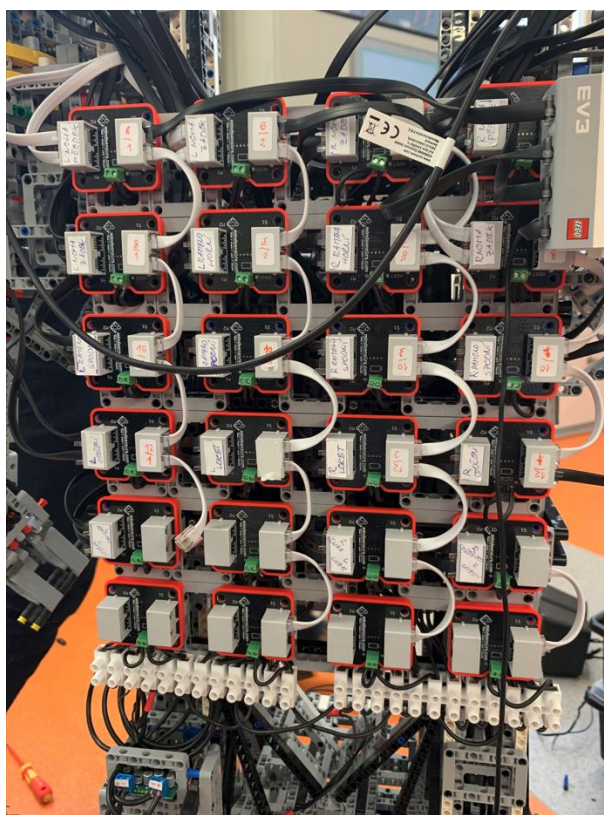
Obrázek 4.2. Zapojení NXTMMX na Robotovi Ludvíkovi. [17]
