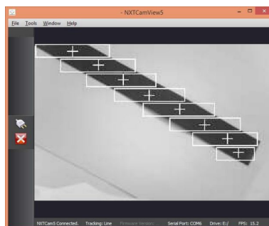
Obrázek 3.4. Ukázka detekce čáry pomocí NXTCam5. [16]
