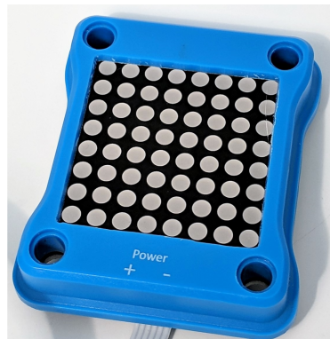
Obrázek 2.9. Světelná matice - LED Matrix. [14]
