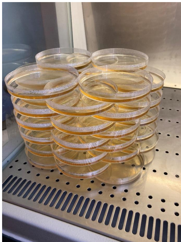
Obr. 34: Ukázka sušení agarového média v otevřených Petriho miskách.
