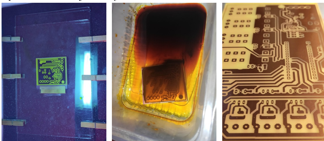
Obr. 8.2.: Osvit, leptání a hotový dvouvrstvý plošný spoj
