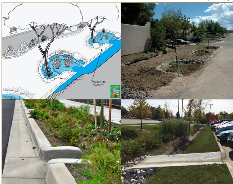
Obr. 2.6.: Způsoby odvodnění cest [29, 30]
