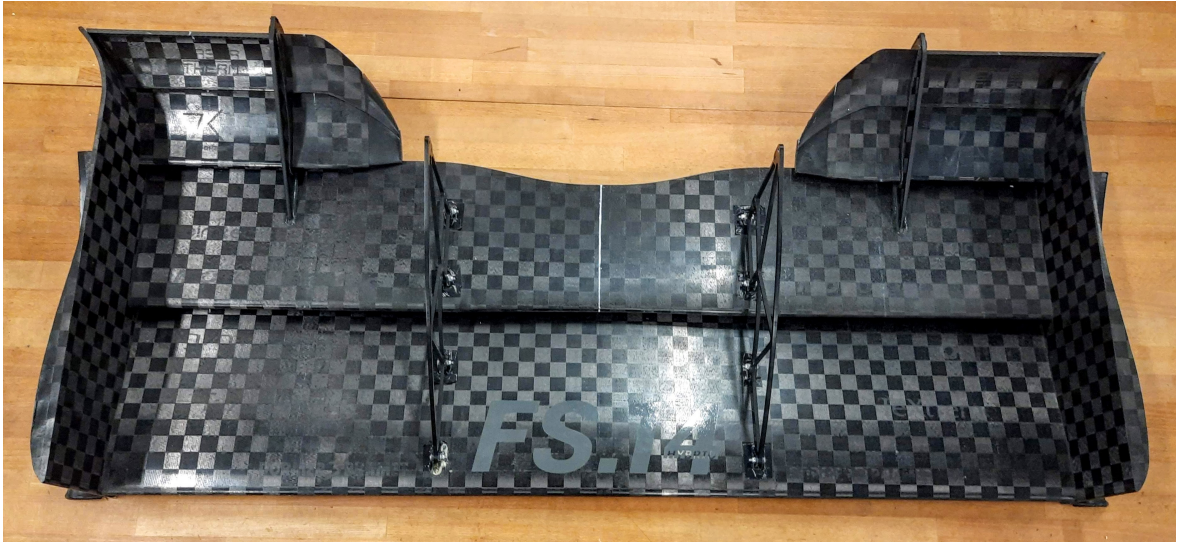
Obr. 43: Přední přitlačné křídlo vozu FS.14
