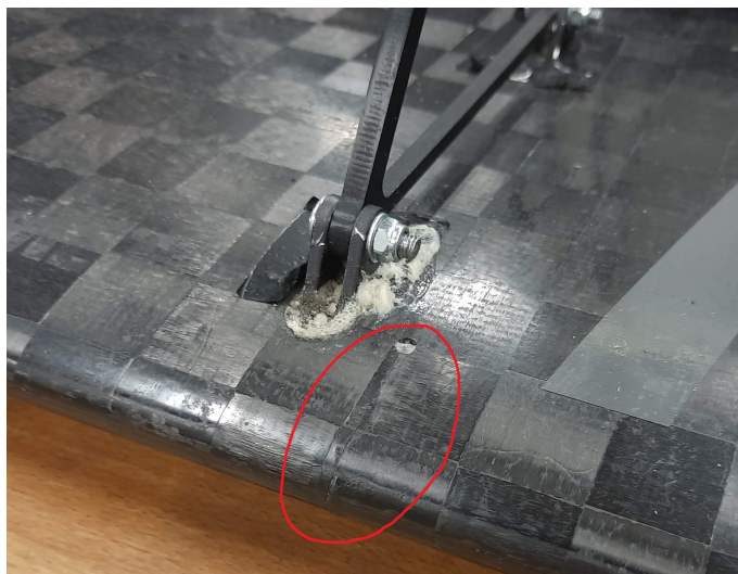
Obr. 44: Prasklina na hlavním profilu
