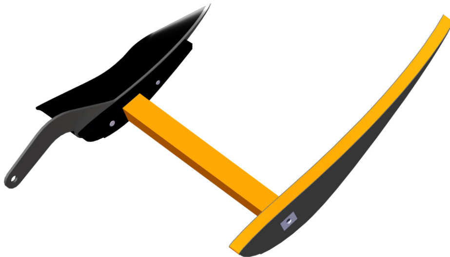
Obr. 25: Vnitřní skladba vnitřní klapky vozu FS.13
