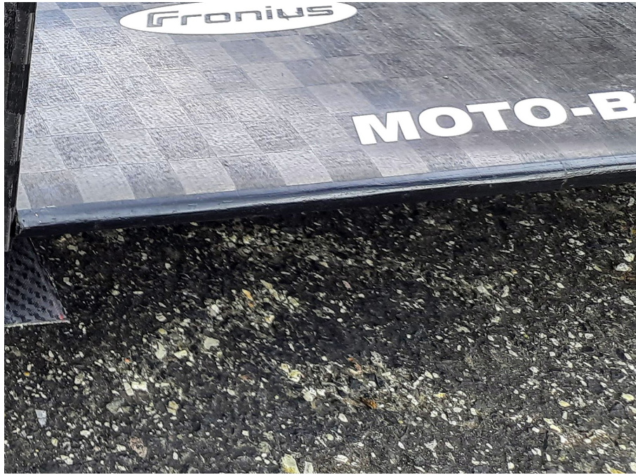
Obr. 30: Opravená náběžná hrana hlavního profilu vozu FS.13
