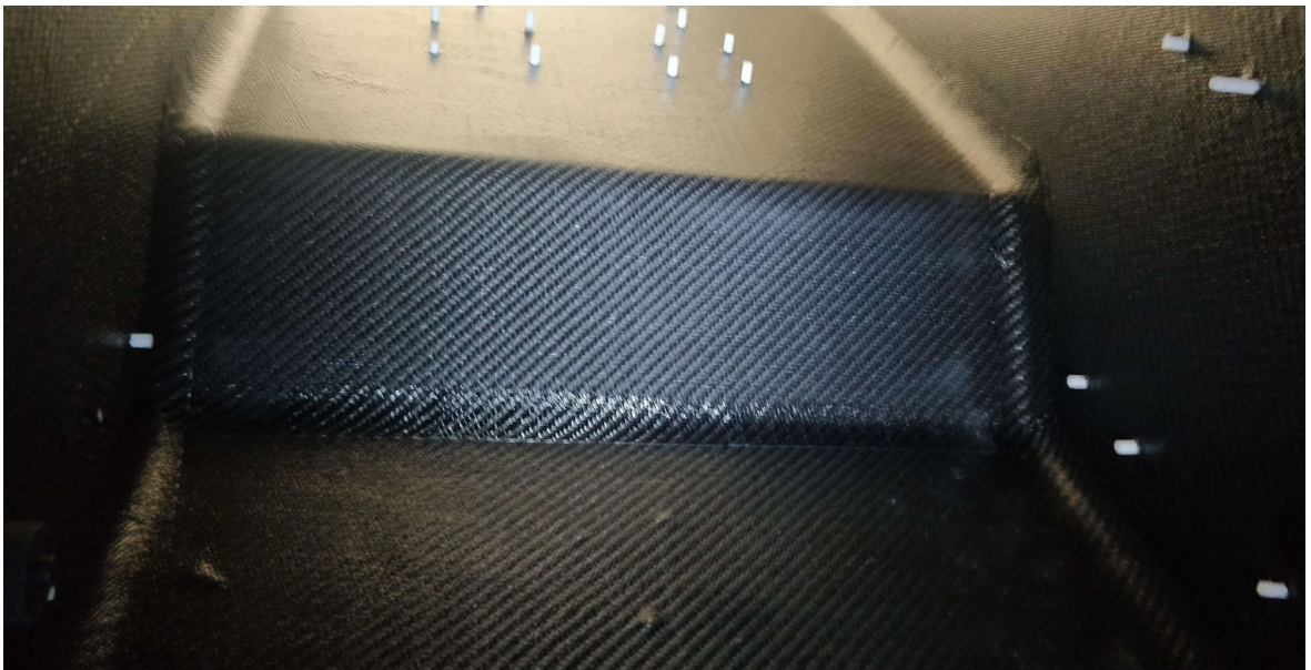
Obr. 7: Laminace předsycenou tkaninou
