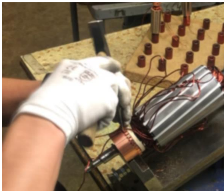
Obrázek 19: Operace č. 2 - Úder za pomoci důlčíku a kladiva
