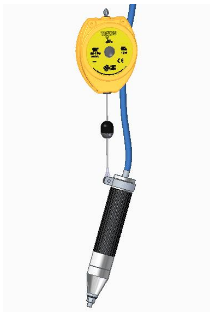
Obrázek 27: Závěs úderníku na pružinovém balancéru
