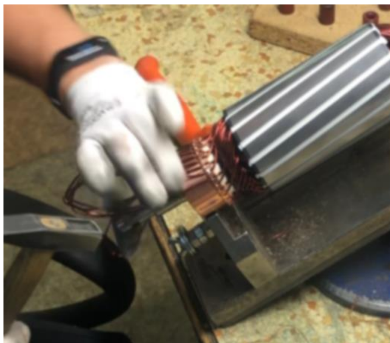
Obrázek 21: Operace č.4 - Odlamování drátů
