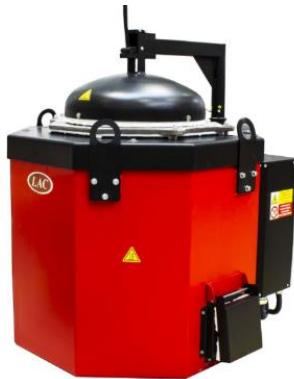
Obrázok 47, Kelímková indukčná pec s vrchným otvorom
