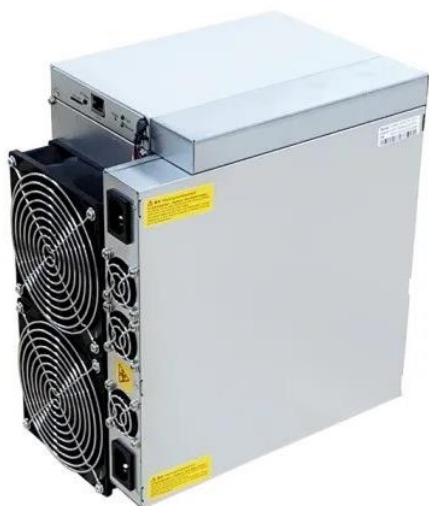
Obrázok 20, Ťažiaci stroj AntMiner S17+, vzduchom chladený
