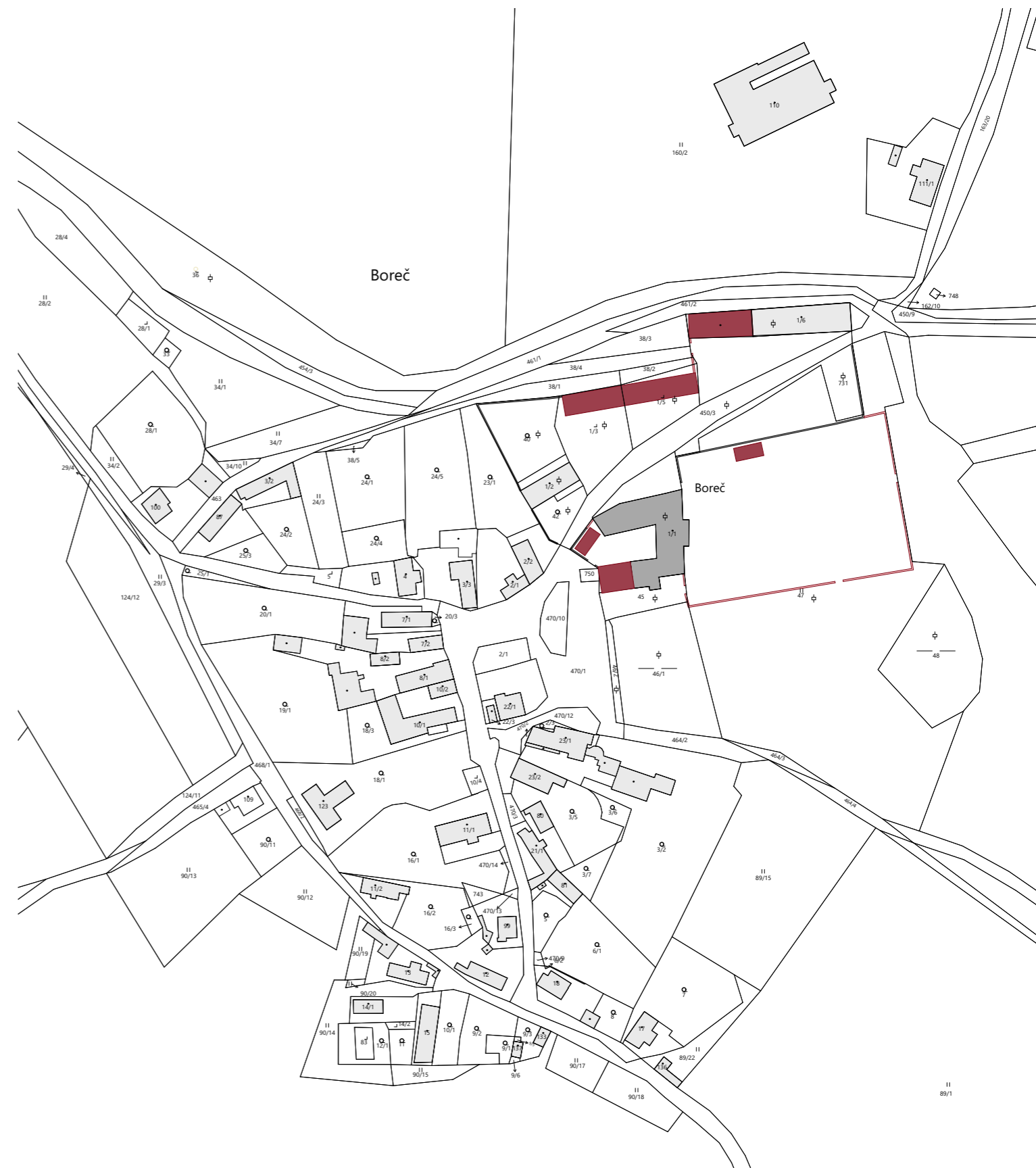
katastrální mapa navrhovaného stavu, včetně vyznačení stávajících a navrhovaných ohradních zdí (prostupnost celého areálu je zachována)
