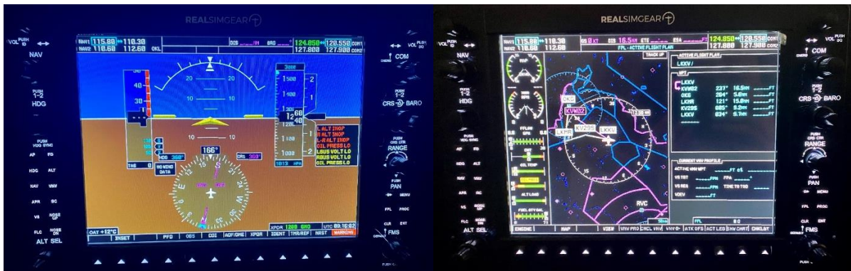
Obrázek 7: Detail PFD a MFD simulátoru Beechcraft 58 na ÚLD FD ČVUT
