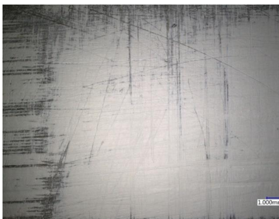
Obrázek 42 - Vzorek hladký po tmelení sprejem
