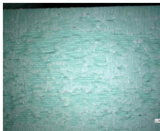
Obrázek 41 - Povrch členitého vzorku po broušení
