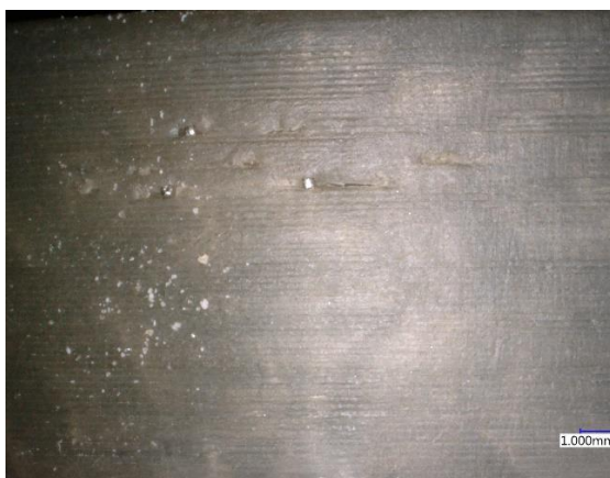
Obrázek 50 - Hladký vzorek po kuličkování
