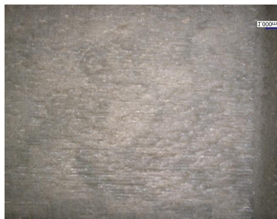
Obrázek 51 - Členitý vzorek po kuličkování
