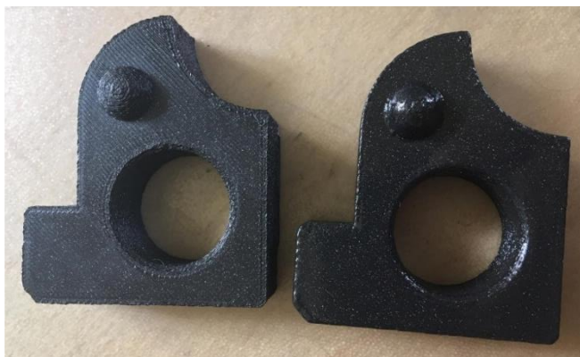
Obrázek 36 - Vzorek před vyhlazením v parách (vlevo) a po vyhlazení (vpravo)
