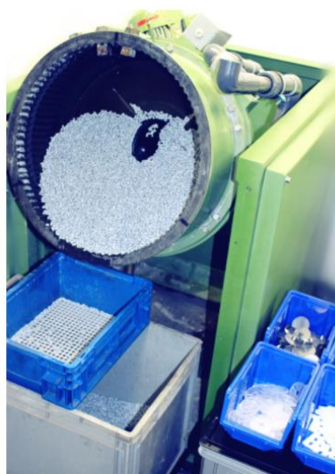
Obrázek 18 - Rotační omílací zařízení [74]
