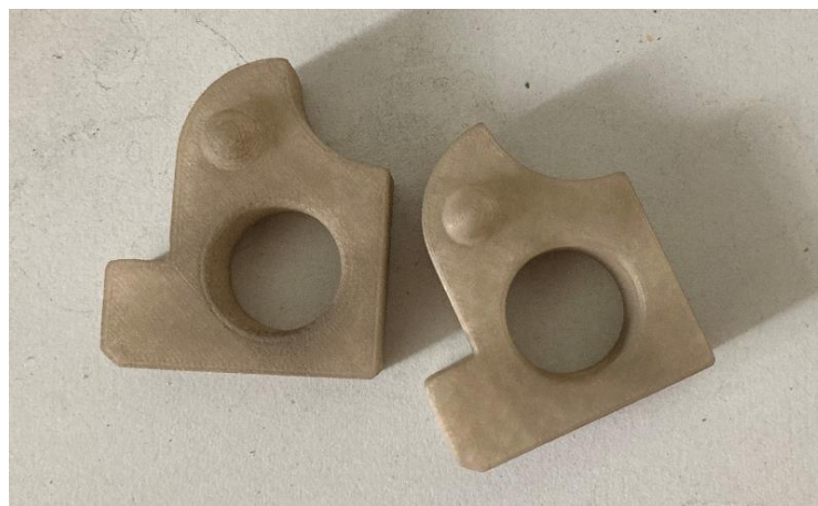
Obrázek 34 – Vzorok (členitý vlevo a hladký vpravo) po kuličkování
