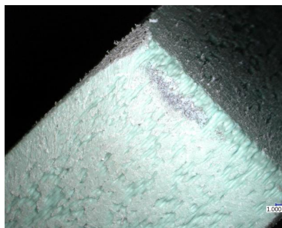
Obrázek 49 - Členitý vzorek po omílání (2 hodiny)
