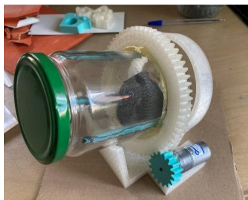
Obrázek 30 - Omílačka vlastní výroby
