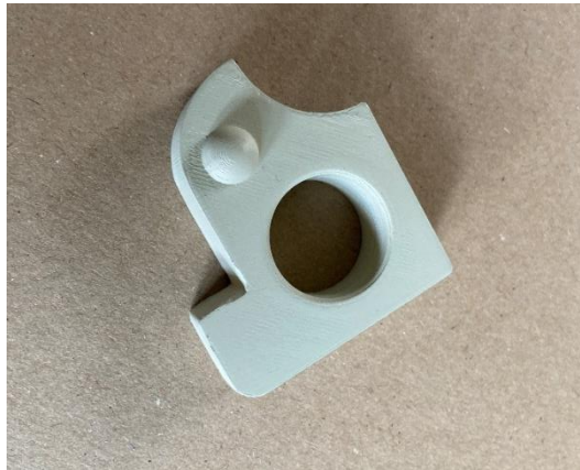
Obrázek 31 – Vzorek s hladkým povrchem po aplikaci tmelu ve spreji
