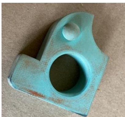
Obrázek 29 - Hladký vzorek po broušení (hnědé skvrny) a omílání (tmavé hrany vzorku)
