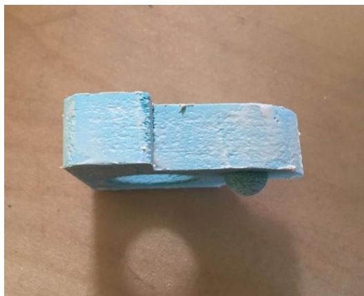
Obrázek 32 – Členitý vzorek po aplikaci dvousložkového tmelu (před obroušením)
