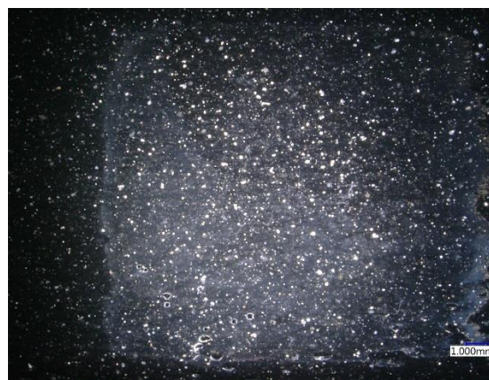
Obrázek 57 - Členitý vzorek po 180 minutách v parách acetonu
