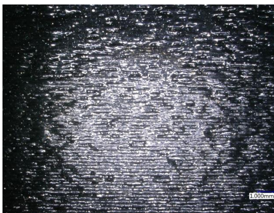
Obrázek 56 - Členitý vzorek po 90 minutách v parách acetonu
