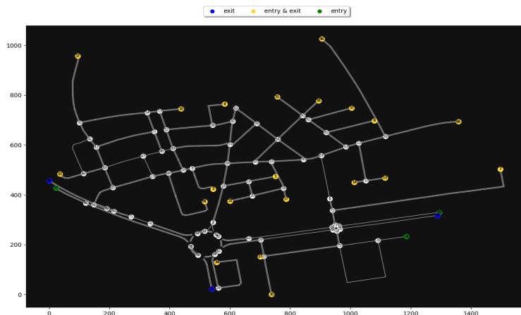
Obrázek 5.1. Ukázka silniční sítě vykreslené knihovnou matplotlib . Modře jsou vyznačeny koncové křižovatky, zeleně počáteční a žlutě křižovatky, které jsou jak koncové tak počáteční. Čísla zobrazená u souřadnicových os jsou v jednotkách metrů.
