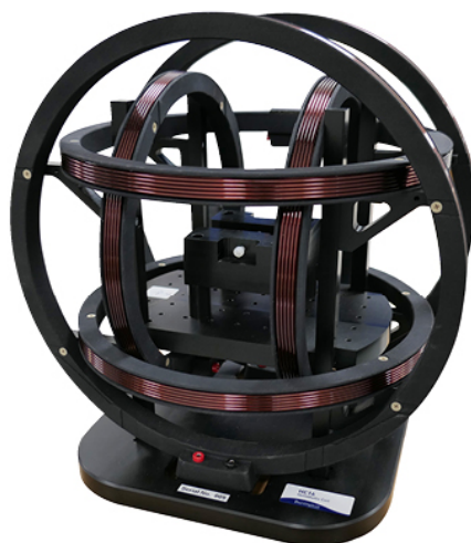
Obrázek 2.5: Helmholtzovy cívky HC16 350mm, Bartington, převzato z [19]
