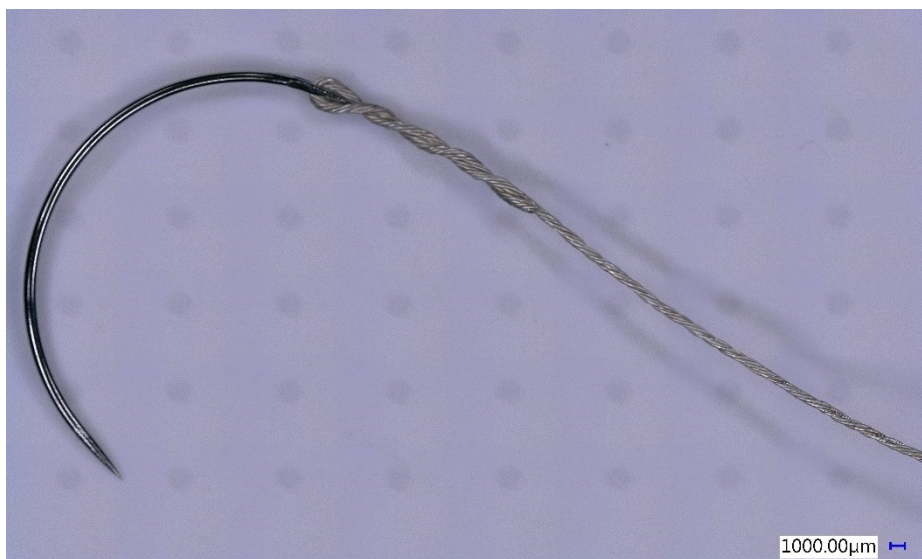
Obrázek 2: Splétané lanko ze slitiny hořčíku a zinku připevněné ke stehovací jehle. Převzato z [18].
