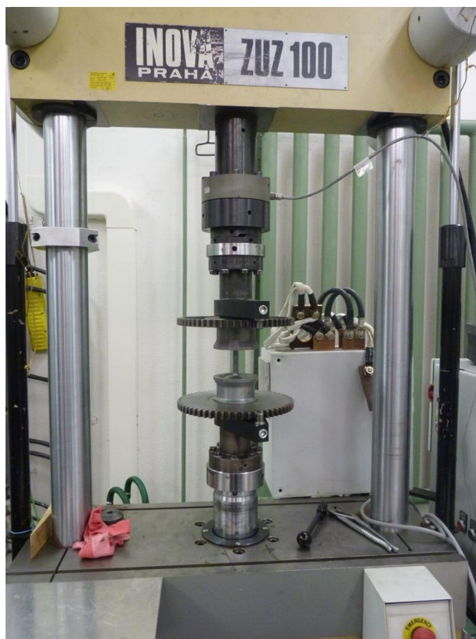
Obr. 8 Elektrohydraulický stroj INOVA ZUZ 100 kN s upnutým válcovým tělesem
