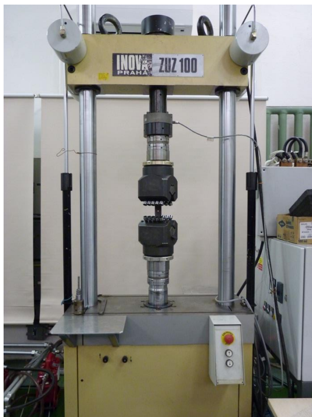
Obr. 9 Elektrohydraulický stroj INOVA ZUZ 100 kN s upnutým plochým tělesem
