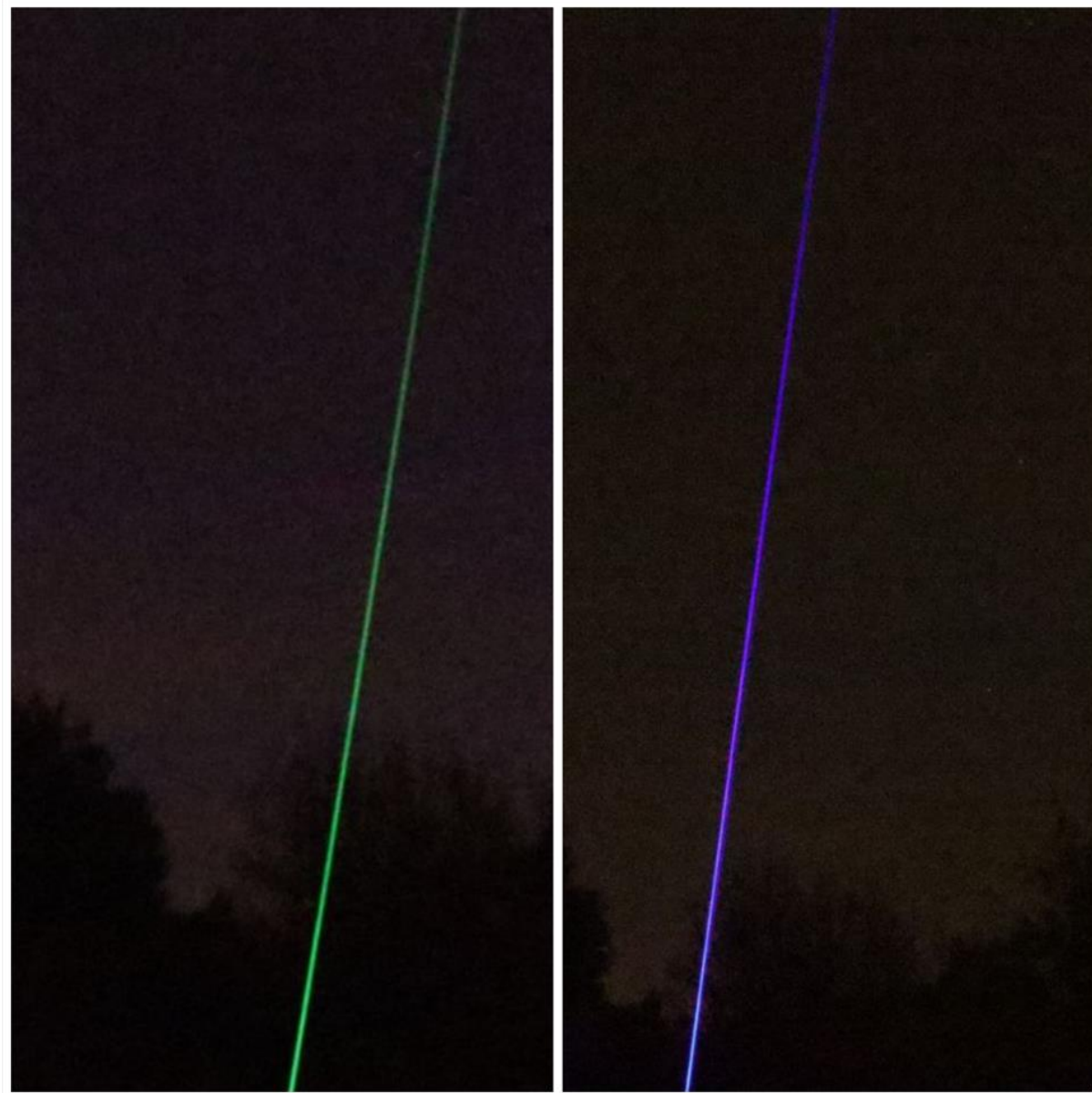
Obrázek 20 Srovnání viditelnosti laseru podle barvy [Autor]
