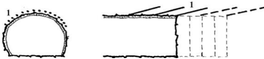
Obr. 45 Predstihové opatrenia – schéma predháňaných ihliel (1 – ocelové ihly) [31]
