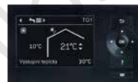
Regulace Vitotronic s jednoduchou obsluhou a grafickým displejem.
