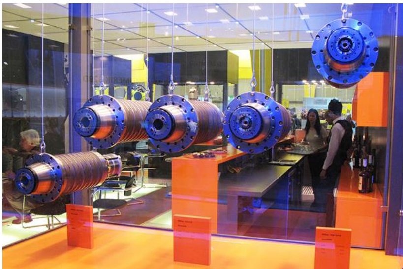
Obr. 32: Ukázka rodiny vřeten se stejnými zástavbovými rozměry a odlišnými technologickými parametry (prezentace firmy Franz Kessler na veletrhu EMO).
