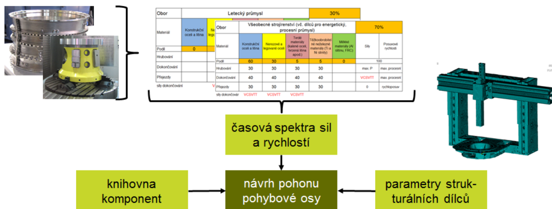
Obr. 30: Schéma návrhu pohonů lineárních os; uvažovaná technologie obrábění ovlivňuje dimenzování pohonů skrz časová spektra zátěžných sil a rychlostí.
