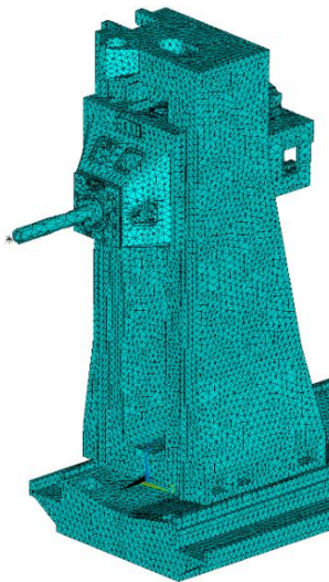
Obr. 71: Vstupní geometrie a model MKP pro topologickou optimalizaci stojanu
