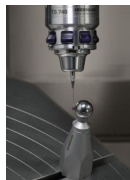
Obr. 34: Přímá metoda kompenzace - obrobková sonda (převzato z materiálů HEIDENHAIN [134]).
