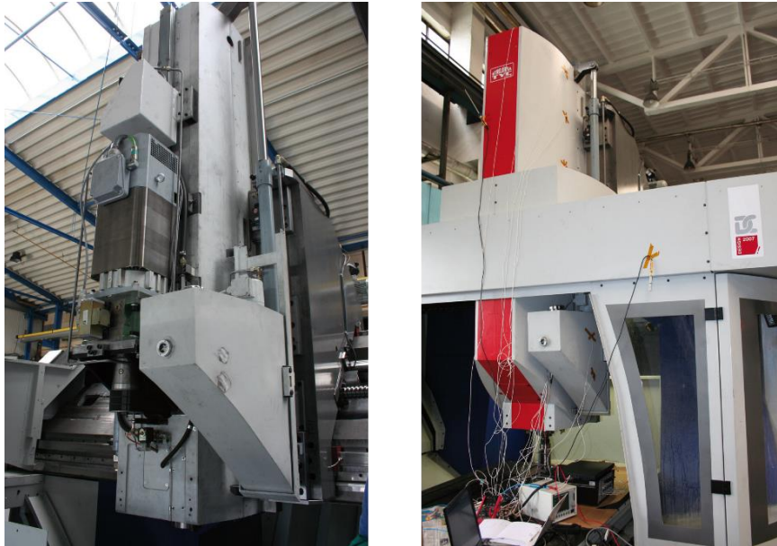
Obr. 20: Multifunkčním obráběcím centru portálové konstrukce bez a s krytváním během teplotně-deformačních experimentů.
