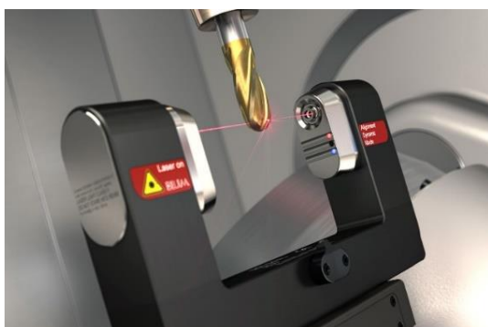
Obr. 33: Přímá metoda kompenzace - nástrojová sonda (převzato z materiálů společnosti Blum [133]).
