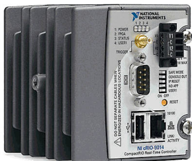
Obr. 160: Řídicí kontrolér cRIO-9014, [268].
