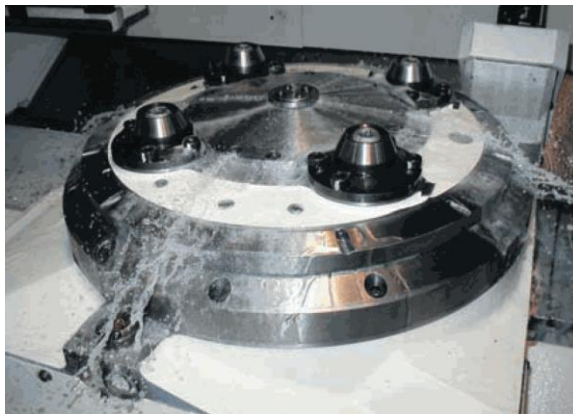
Obr. 9: Oplach otočného stolu pod paletou, převzato z katalogu firmy Okuma [38].
