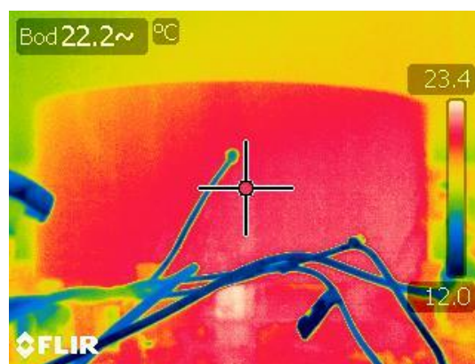
Obr. 125: Příklad teplotního pole obrobku na konci experimentu s mokřím obráběním.
