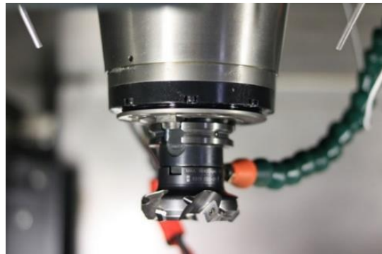
Obr. 105: Infračervené (IR) teplotní čidlo pro měření teploty nástroje.
