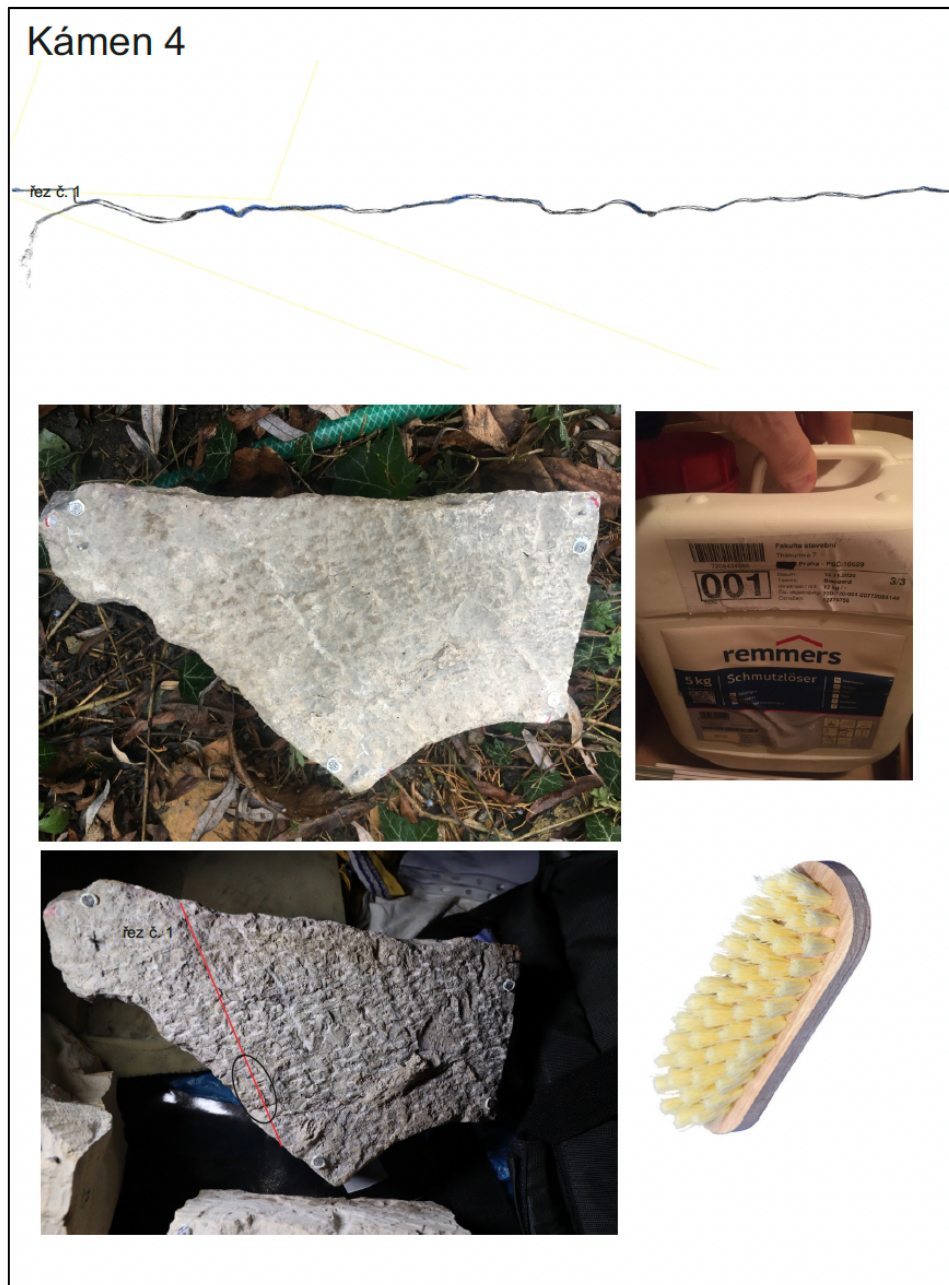
Obr. 12 Vápencový fragment ošetřen prostředkem Schmutzlöser firmy Remmers s vyznačením řezu sloužícího k vyhodnocení změn po restaurátorských zásazích.
