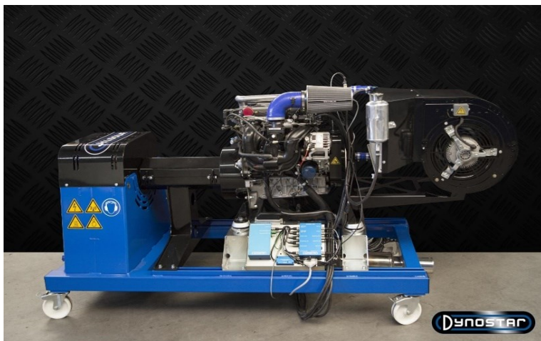
Obr. 1: Sestava měřicího zařízení, pro zkoušení parametrů motoru [56]
