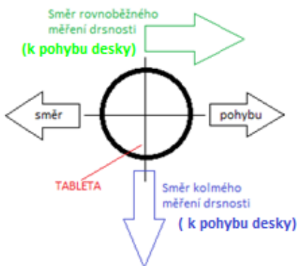
Obr. 3: Popis směrů měření drsnosti
