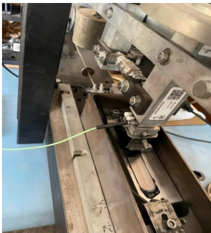
Obr. 12: Detailní pohled na tribometr TOP 3 – měření koeficientů tření různých maziv
