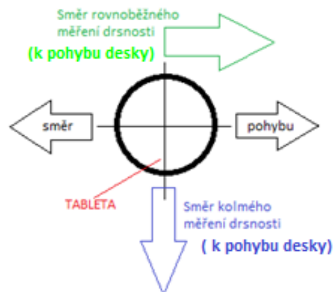
Obr. 38: Popis směrů měření drsnosti
