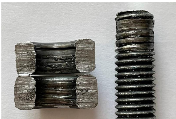
Obr. 32: Příklad z praxe-selhání závitu šroubového spoje.
