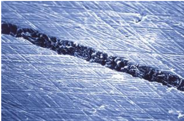
Obr. 20: Struktura povrchu válce se stopou bez valu, vytvořenou laserovým honováním [44]
