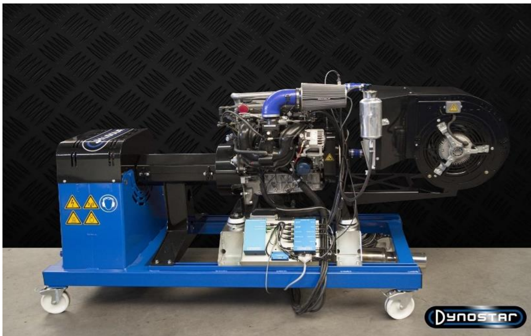
Obr. 36: Sestava měřícího zařízení, pro zkoušení parametrů motoru [93]
