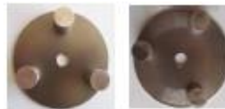
Obr. 56: Funkční dvojice OCEL / DURAL před (vlevo) a po testu (vpravo)
