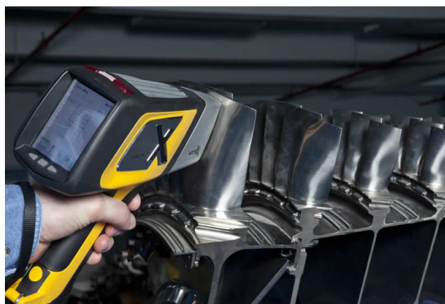
Obr. 54: Spektrometr BAS Delta pro určování chemického složení materiálu [P1]
