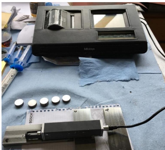
Obr. 39: Pracoviště měření drsností tablet a desek
