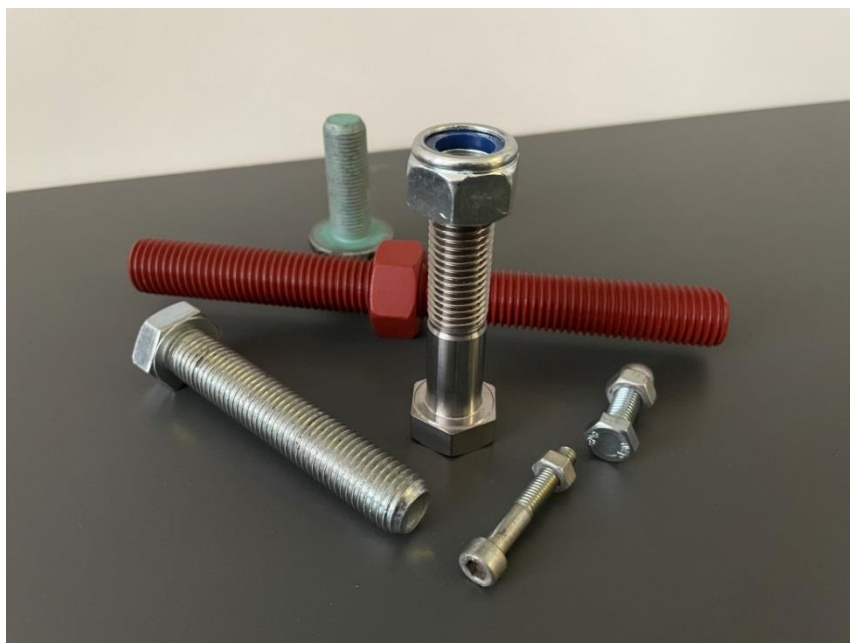
Obr. 22: Šrouby s různou úpravou povrchů.
