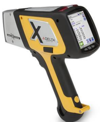
Obr. 54: Spektrometr BAS Delta pro určování chemického složení materiálu [P1]
