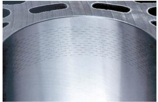
Obr. 21: Úprava povrchu vyhonovaných vývrtů válců - Laser honing [44]
