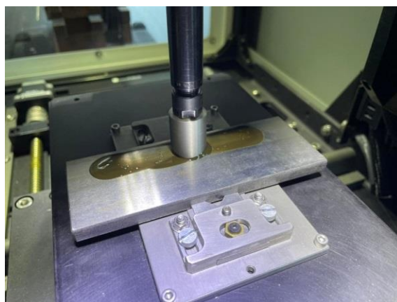
Obr. 44: Kalibrační měření na tribometru Rtec
