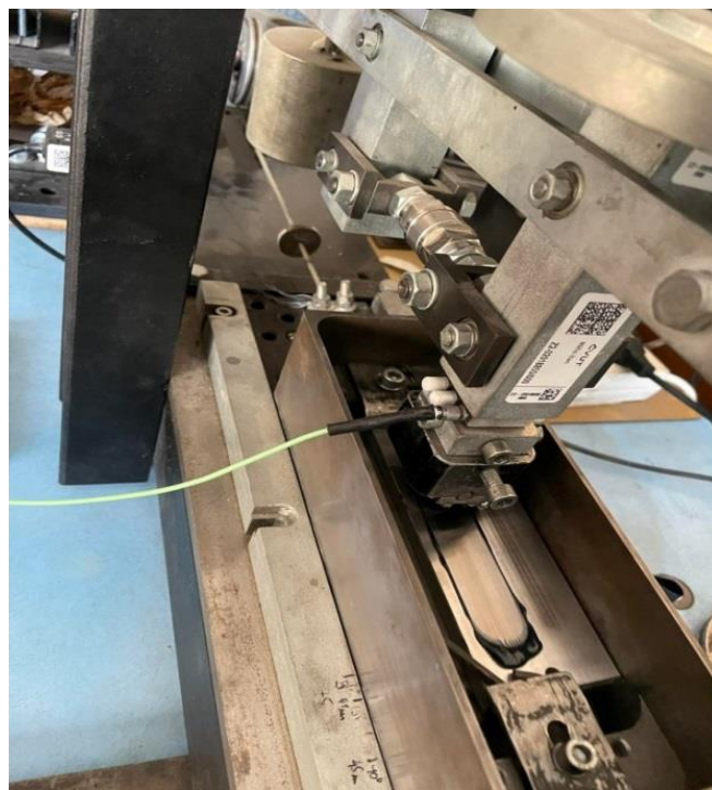
Obr. 43: Detailní pohled na tribometr TOP 3 – měření koeficientů tření různých maziv
