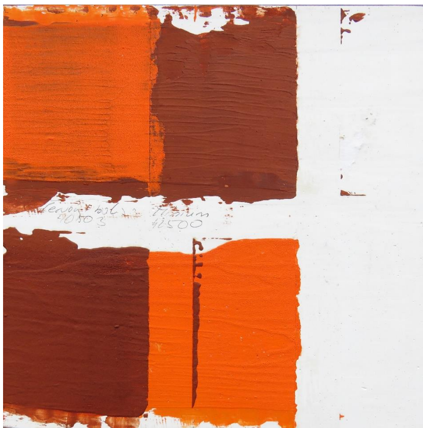
Obr. 33. Fotografie laboratorního standardu dvou překrývajících se barevných vrstev nanášených na nakřídované desce.
