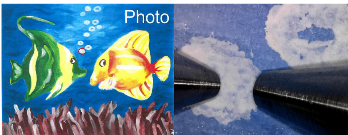
Obr. 20. Vlevo: fotografie celého obrázku dvou rybek. Vpravo: detailní fotografie analyzovaného bodu nacházejícího se uprostřed konců primární (napravo) a sekundární (nalevo) polykapilární optiky.
