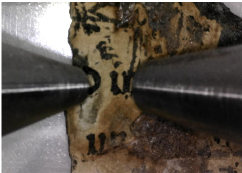
Obr. 36. Fotografie z konfokální \mu -RFA vzorku inkoustu na pergamenu.
