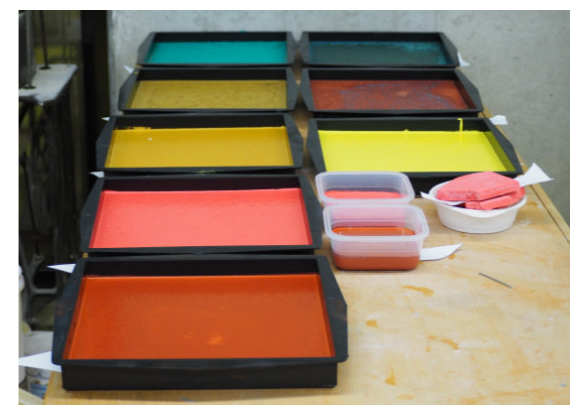
△ Obr. 32 Odlité experimentální betonové desky v plastových formách
