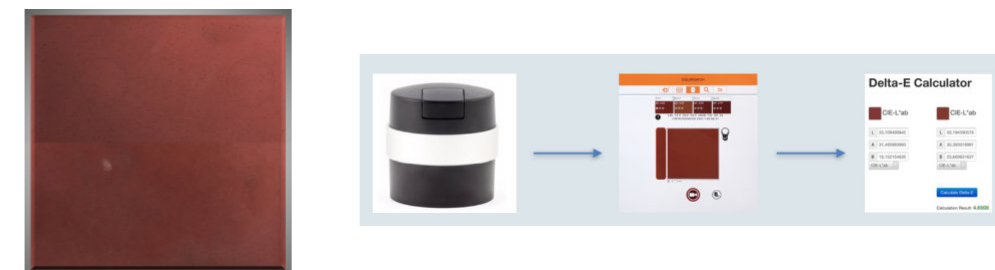
△ Obr. 3 Výroba experimentálních vzorků a následné schéma měření proměny barevnosti v průběhu času
