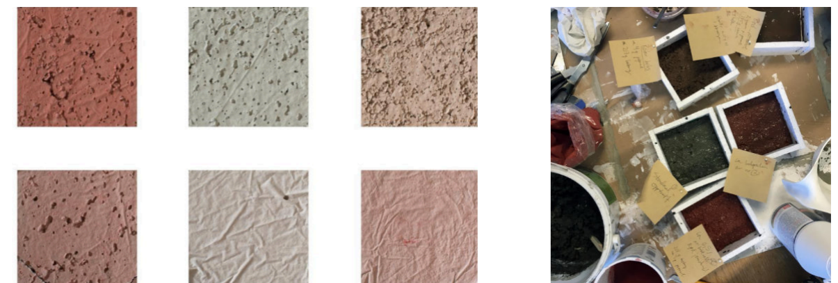
▽ Obr. 24 Testování různých betonových směsí. Poměr vody, druhu, barvy a poměru pigmentu v kombinaci s cementem a štěrkem z norského západního pobřeží [60]
