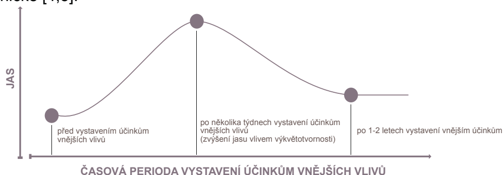
△ Obr. 16 Příklad proměny barevnosti červeně probarveného betonu v závislosti na čase v důsledku vystavení účinkům vnějších vlivů [15]
