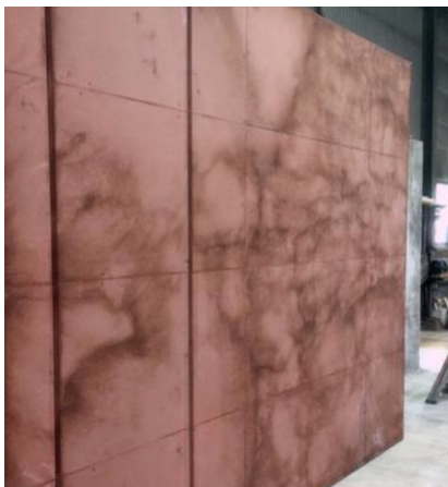
▽ Obr. 74 Test pigmentace betonových prvků v měřítku 1:1 [61]
