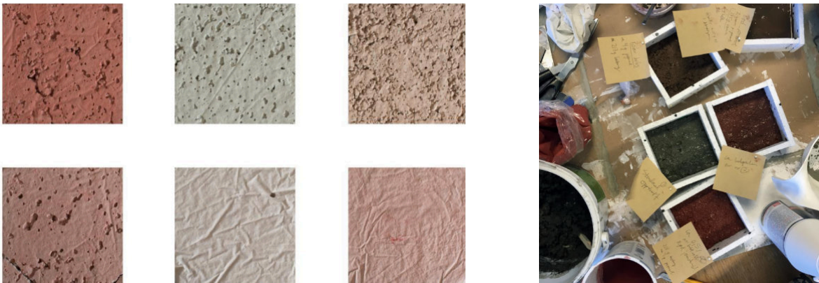
▽ Obr. 73 Testování různých betonových směsí. Poměr vody, druhu, barvy a poměru pigmentu v kombinaci s cementem a štěrkem z norského západního pobřeží [60]
