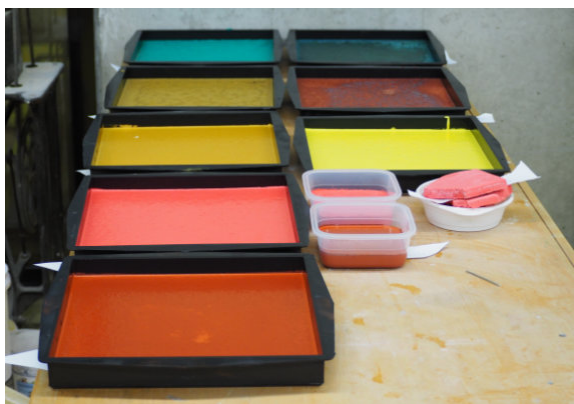
△ Obr. 116 Odlité experimentální betonové desky v plastových formách
