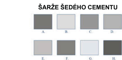
△ Obr. 7 Vliv použitého cementu na výslednou barevnost [8]
