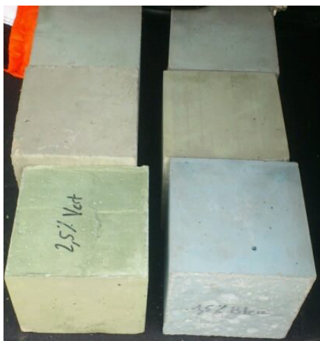
◁ Obr. 29 Před zahájením výstavby bylo vytvořeno šest testovacích probarvených betonových vzorků . Následně byl proveden vzorek pro ověření výběru barvy přímo v místě výstavby v měřítku 1:1 [32]
