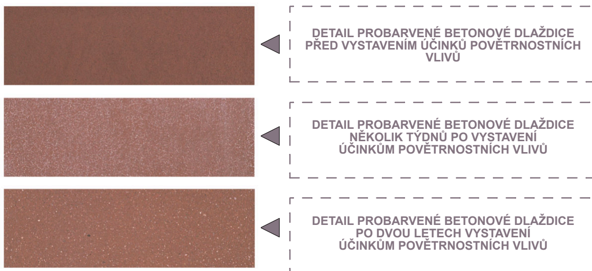
△ Obr. 15 Příklad projevů a vymizení výkvětovnosti v závislosti na čase, detail povrchu [14]
