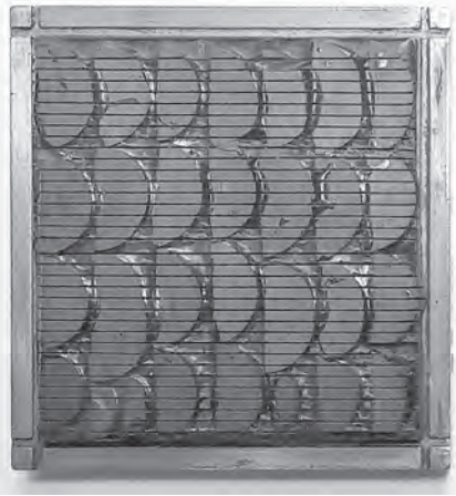
Obr. 4 – Přípravek zatmeleného polotovaru (plátek syntetického rubínu) pro další řezání, foto archiv autora
