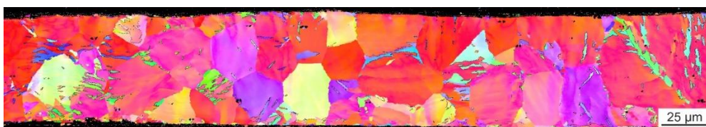
Obr. 12: EBSD IPF mapa \sim 50 \mu\text{m} drátu z komerčně čistého Mg.
