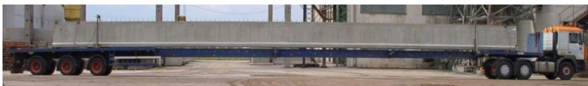
Obr. 19: Rozměry prefabrikovaných dílů jejich transport značně komplikují a představují tak riziko pro harmonogram projektu. Zdroj: Prefa Nový Bydžov, a.s., www.prefa-nb.cz
