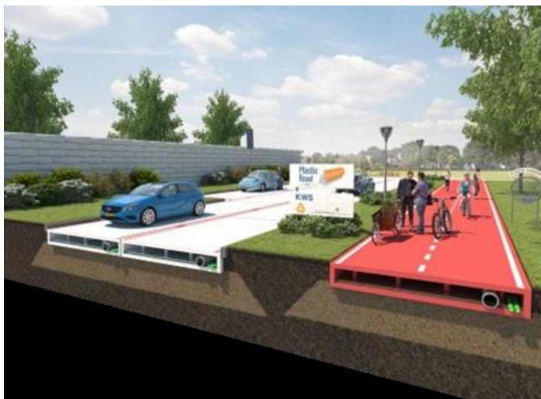
Obr. 13: Návrh kompletního řešení vozovky z plastových prefabrikátů. Zdroj: Společnost PlasticRoad [61].
