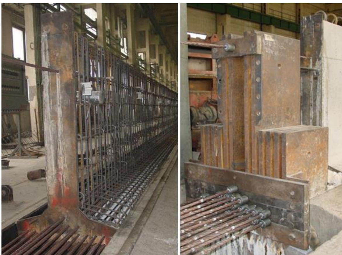
Obr. 21: Příprava předeprutí prefabrikátu. Zdroj: KŠ PREFA, a.s., [76]
