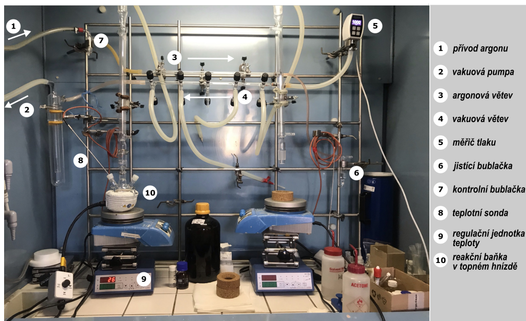
Obr. 4.1: Vakuová linka používaná pro syntézu nanokrystalů CsPbBr 3 .
