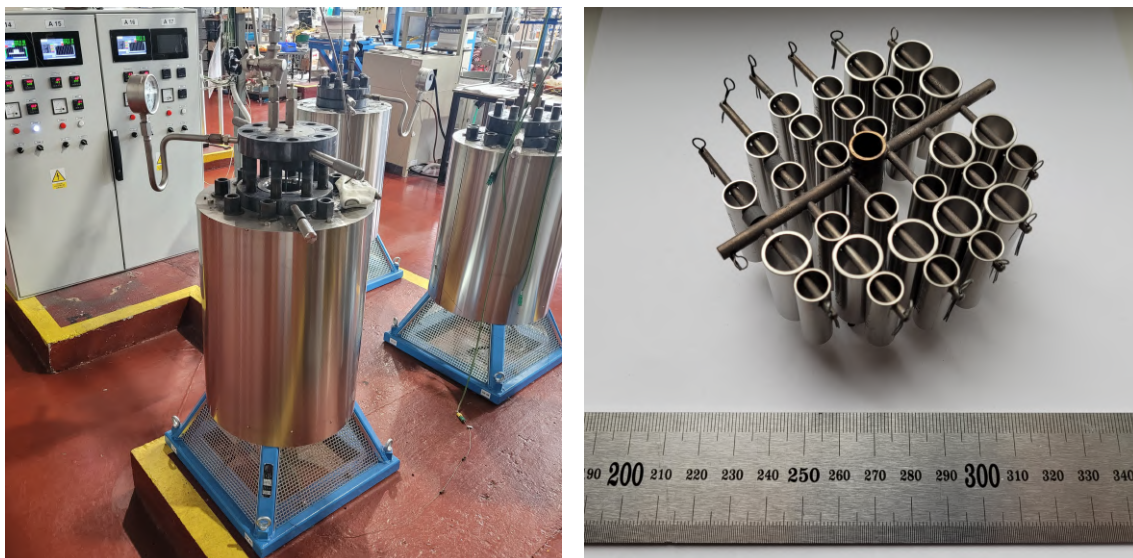
Obrázek 2.6: Použitý autokláv (vlevo) a rozmístění vzorků palivových pokrytí na stojanu před jejich umístěním do autoklávu (vpravo).
