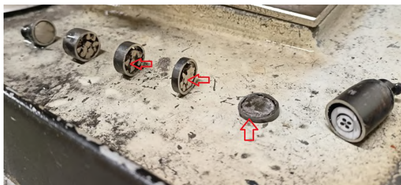
Obrázek 2.11: Rozřezání experimentálního vzorku č. 2 na několik segmentů.
