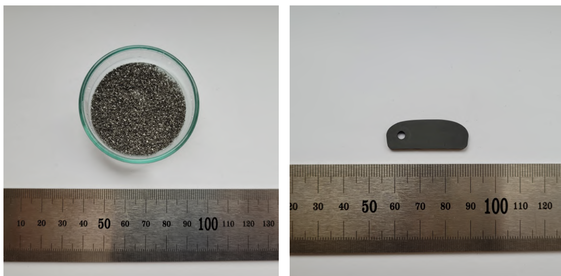
Obrázek 2.2: Špony reprezentující materiál palivové matrice vzniklé obráběním slitiny Zr-Fe-Cu (vlevo), plíšky ze slitiny Zr-Fe-Cu připravené pro korozní zkoušky.
