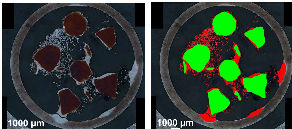
Obrázek 3.21: Analýza zastoupení komponent palivo/matrice pomocí optického mikroskopu ve vrchní části vzorku č. 2 (2.1) po experimentu simulujícím LOCA.
