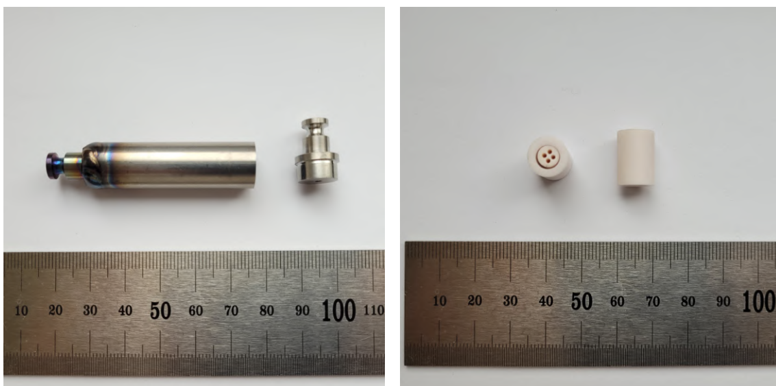
Obrázek 2.4: Palivové pokrytí ze zirkoniové slitiny se zátkami (vlevo) a výplňový váleček z materiálu \text{Al}_2\text{O}_3 (vpravo).
