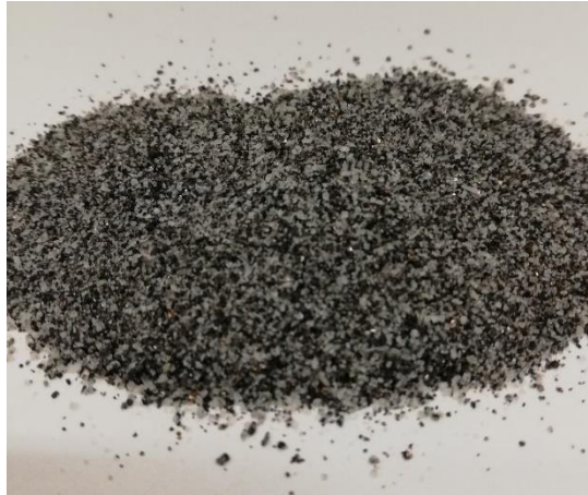
Obr. 3.2 Vzorka PVP-2 v zrnitosti 0,63-0,125 mm použitá v experimentoch.
