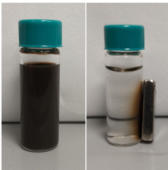
Obr. 1: Interakce nanočástic magnetitu s vnějším magnetickým polem.
