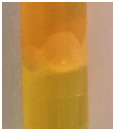
Obr. 7: Zrazenina, ktorá vznikla pri extrakcii Mo pomocou 0,1M 8-HQ v IL z prostredia 3M HNO 3 .
