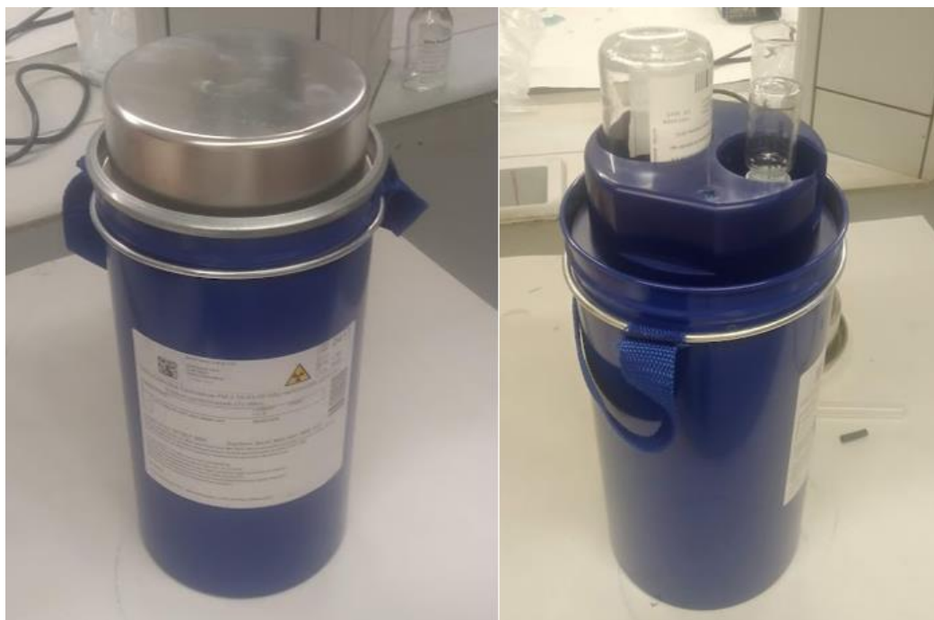
Obr. 1: Medicínsky využívaný Molybdén – Technéciový generátor. (autor: M. Ficiel, 2021)
