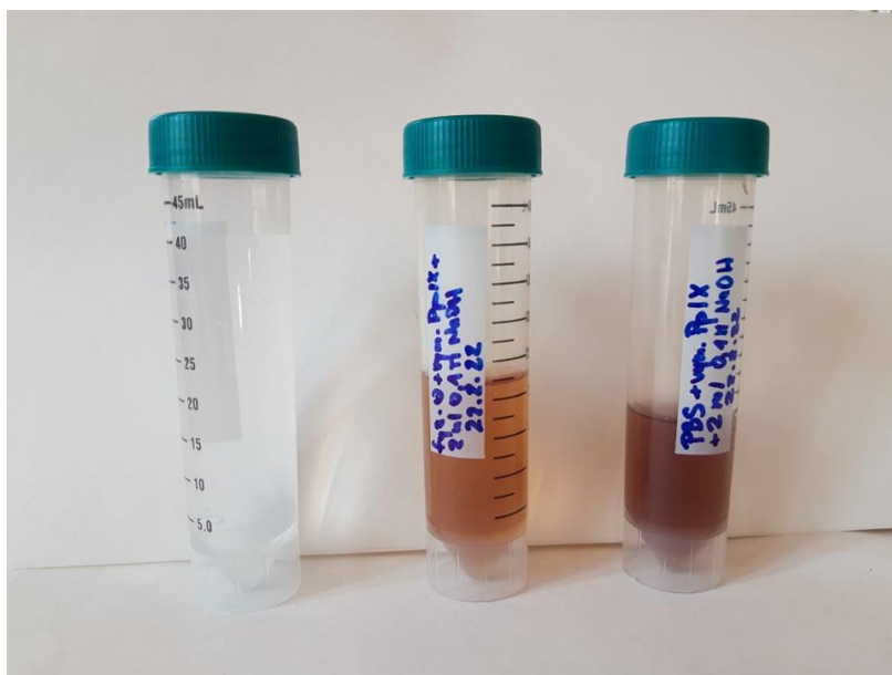
Obr. 16: Zabarvení fyziologického roztoku (uprostřed) a PBS (vpravo) v porovnání s destilovanou vodou (vlevo) po 24hodinovém promývání.
