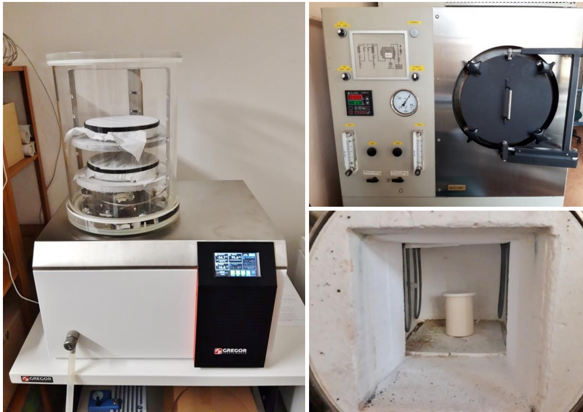
Obr. 4: Lyofilizační aparatura (vlevo) a vnější a vnitřní pohled na žhací pec (vpravo).
