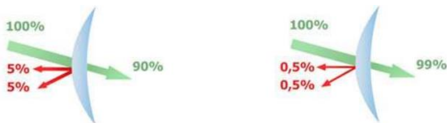
Obrázek 7.1: Grafické znázornění propustnosti a odrazivosti čočky bez antireflexní vrstvy a s antireflexní vrstvou [33]
