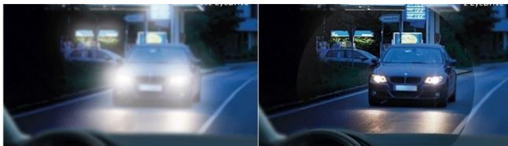
Obrázek 7.2: Ukázka vidění s čočkou bez antireflexní vrstvy a s antireflexní vrstvou [34]
