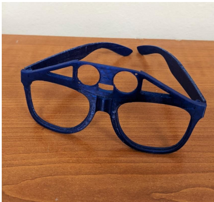
Obrázek 7.4: Model obruby po tisku [vlastní tvorba]
