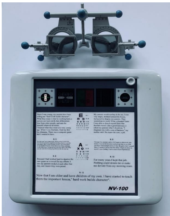
Obrázek 6-3 : : Jednotka do blízka NV-100 pro vyšetření Horizontální a vertikální asociované forie se zkušebnímu obrubou a lineárními polarizovanými předsádky. [Vlastní zpracování]
