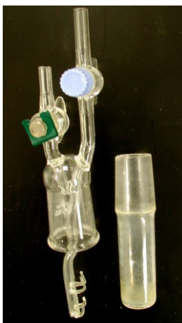
Obr. 4 Nádoba pro studium adsorpce ve vodní fázi [40]
