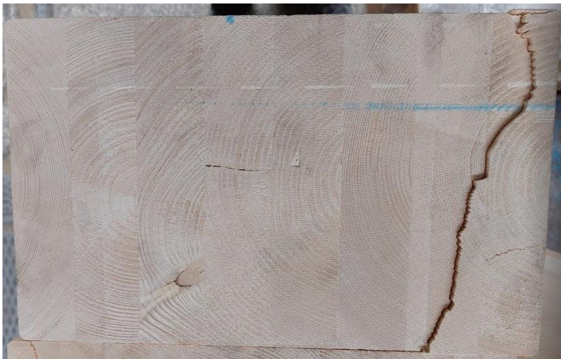
Obr. 79: Detailní pohled na čelo porušeného hranolu. Je patrné, že pravá krajní lamela má výrazně hrubší strukturu letokruhů a strom rostl tedy v jiných podmínkách než strom, ze kterého pochází lamela levé strany. U lamely na pravé straně rostl strom nejspíše výrazně rychleji a měl tedy horší mechanické vlastnosti. Na obrázku je patrné, že v části smykové plochy je kopírován průběh letokruhu. Mohlo se jednat například o tlakové dřevo.
