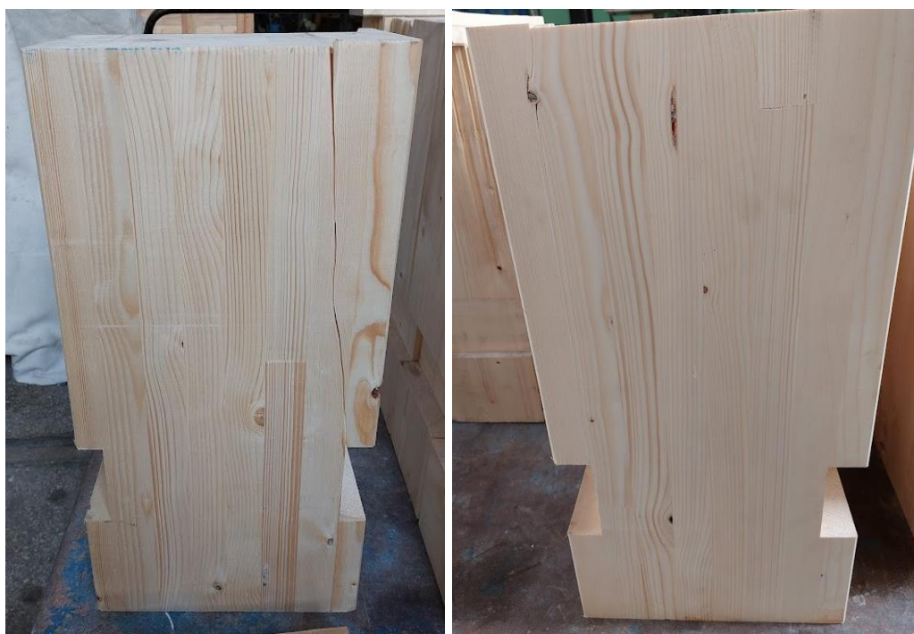
Obr. 81: Způsob selhání těles s ozubem hloubky 30 mm – došlo k usmyknutí smykového ozubu. Smyková plocha není rovnoběžná a je ovlivněna strukturou dřeva.
