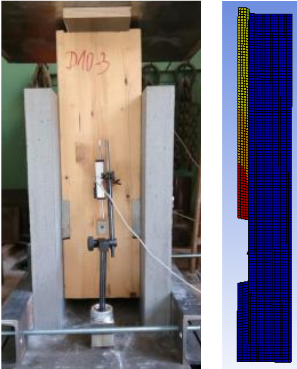
Obr. 68: Vlevo je výsledná deformace experimentálně zkoušeného tělesa. Napravo pak deformovaný tvar dřevěného nosníku série D10 – je zde patrné usmyknutí smykového ozubu. Pro názornost je deformace 3x zvětšena.
