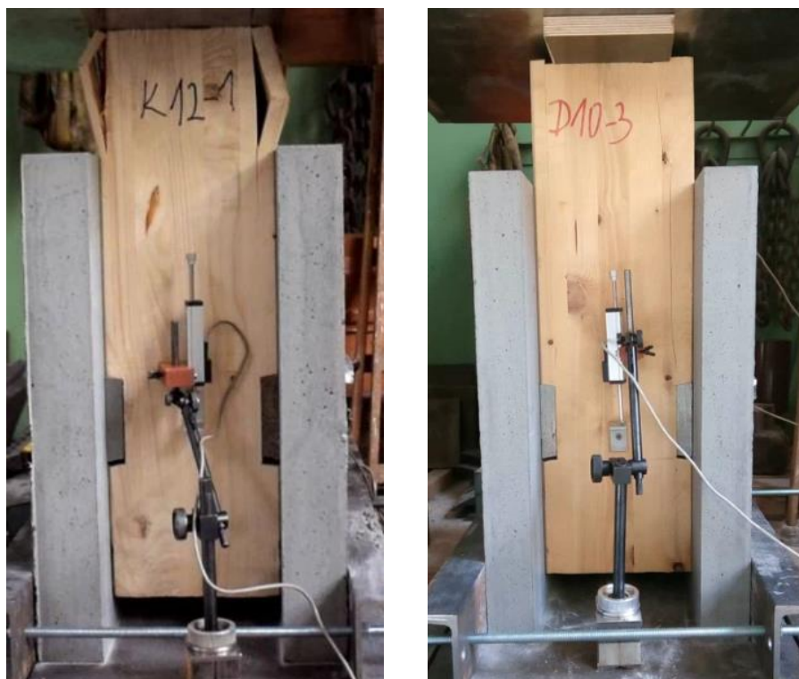
Obr. 52: Vlevo příklad tělesa bez podložky po porušení dřeva smykem, usmyknuté ozuby rozepřeny o zatěžovací desku, vpravo příklad tělesa s podložkou na čele trámu umožňující volné usmyknutí ozubu.
