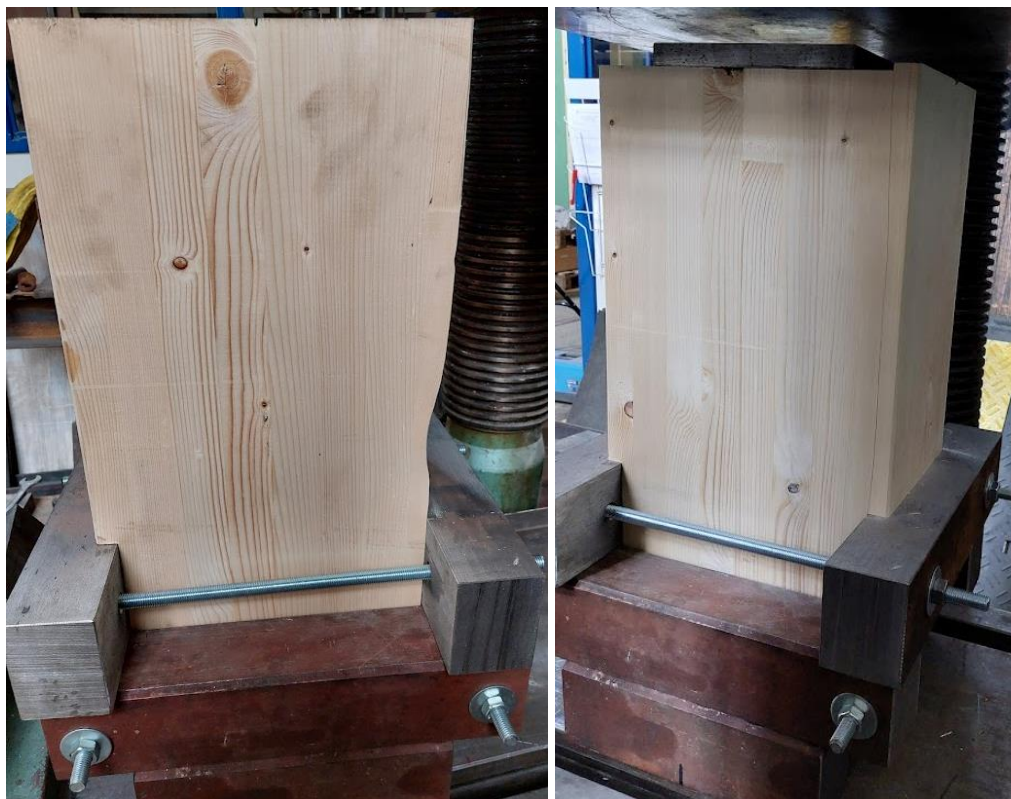
Obr. 80: Způsob selhání těles s ozubem hloubky 20 mm – došlo k usmyknutí smykového ozubu. U levého vzorku došlo k jeho celkovému oddělení.
