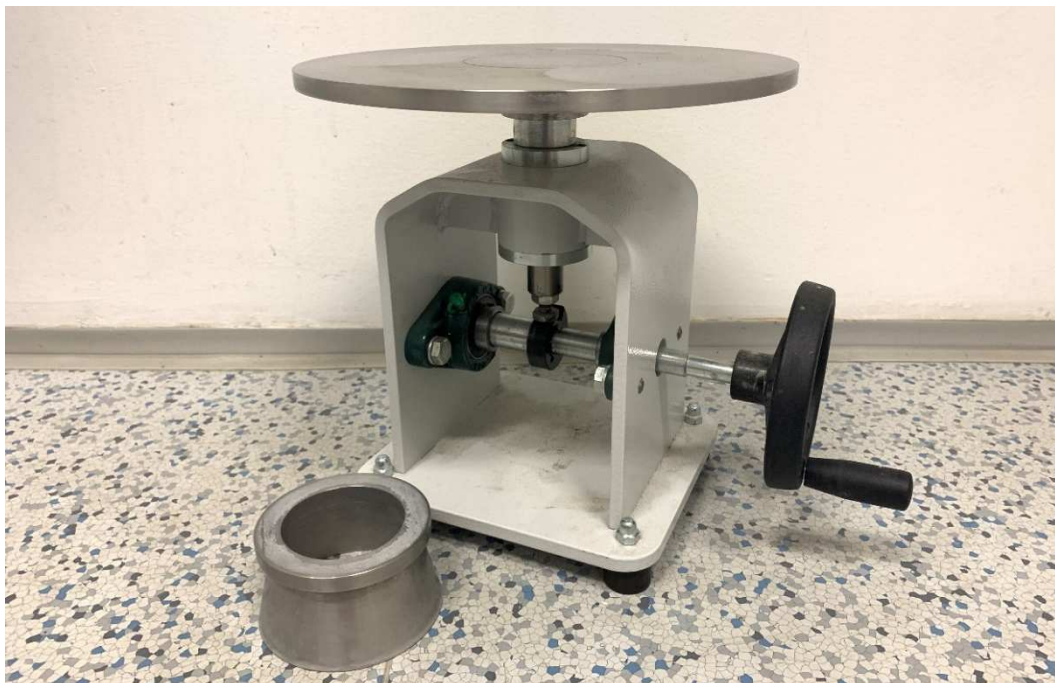
Obr. 4.18: Hägermannův pokleповý stůl spolu s kuželem
