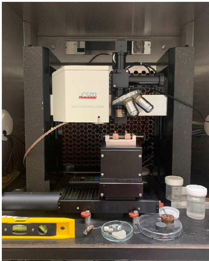
Obr. 4.6: Měřicí soustava nanoindentoru CSM Instruments skládající se z optického světelného mikroskopu a nanoindentačního testeru
