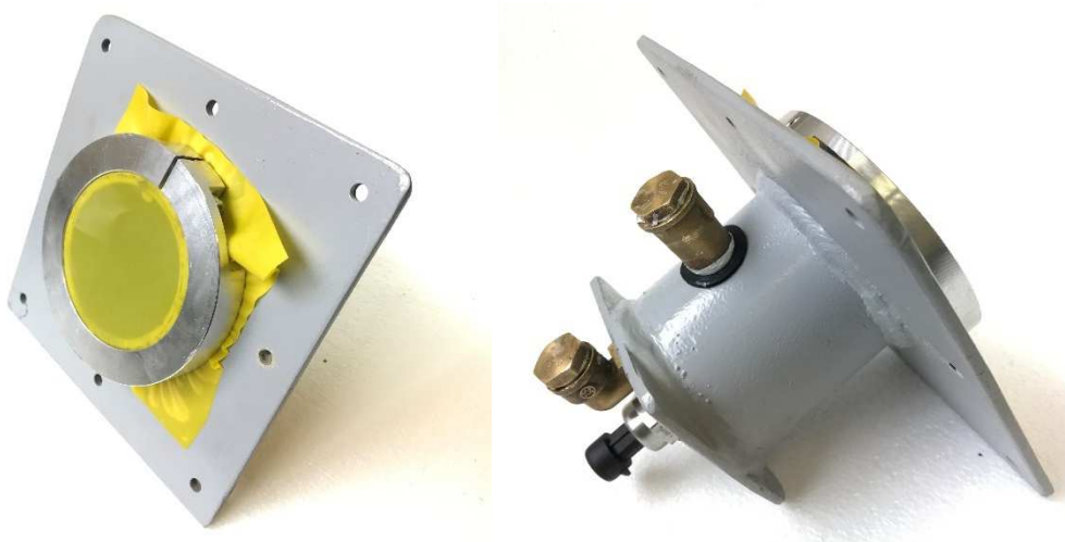
Obr. 4.27: Měřící komora pro měření bočního tlaku betonu na bednění
