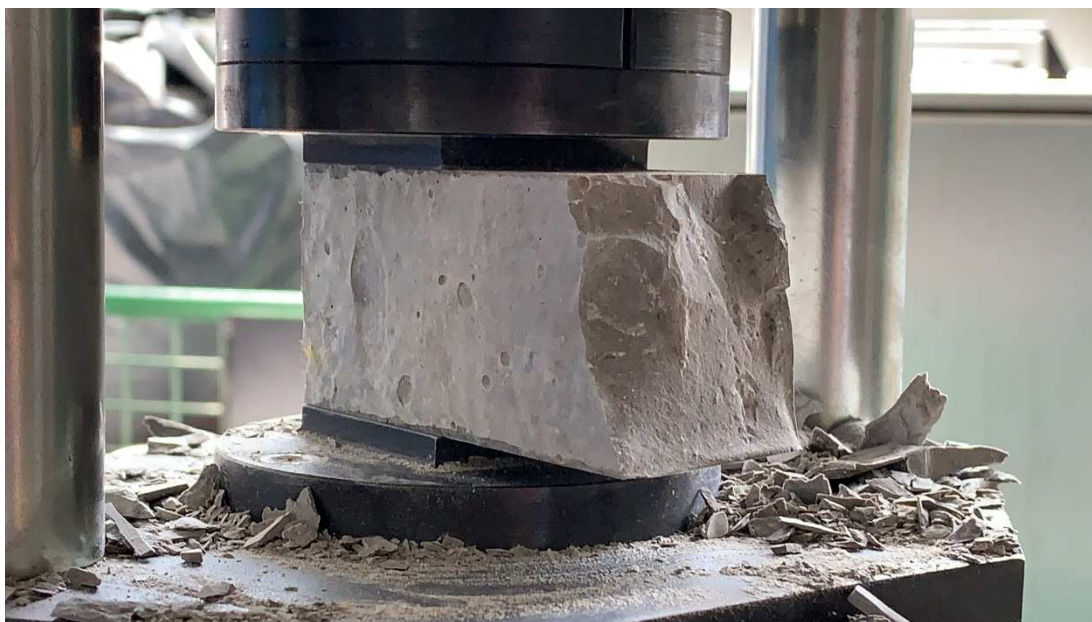
Obr. 4.17: Zkouška pevnosti v tlaku na zbytku trámečku
