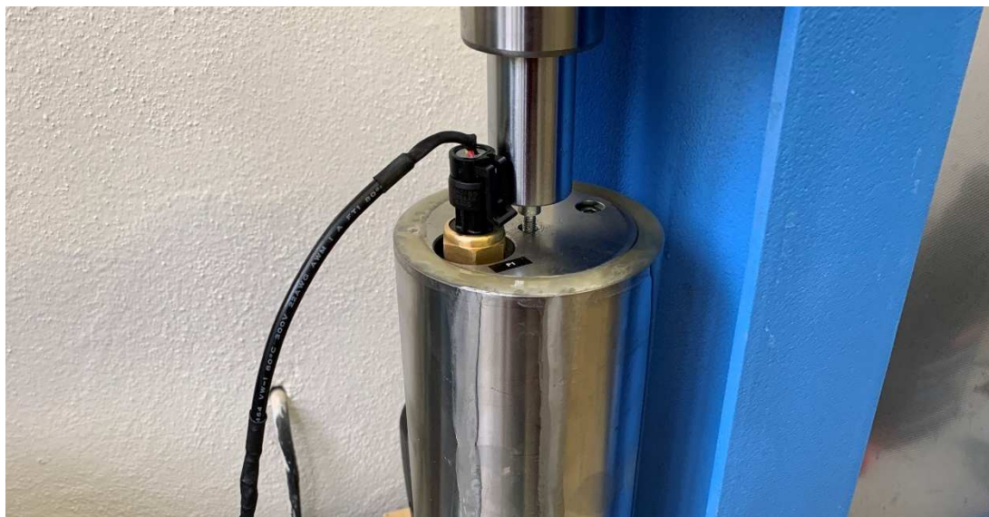
Obr. 5.31: Problém s těsností pístu po změně těsnících kroužků
