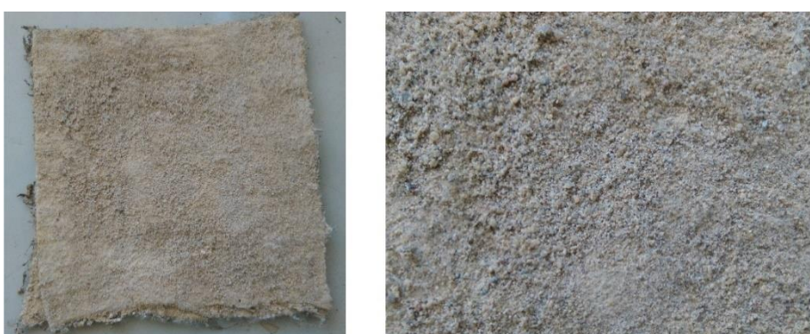
Obrázek 16 Vzorek z malty s kamenivem 0-1 mm [26]
