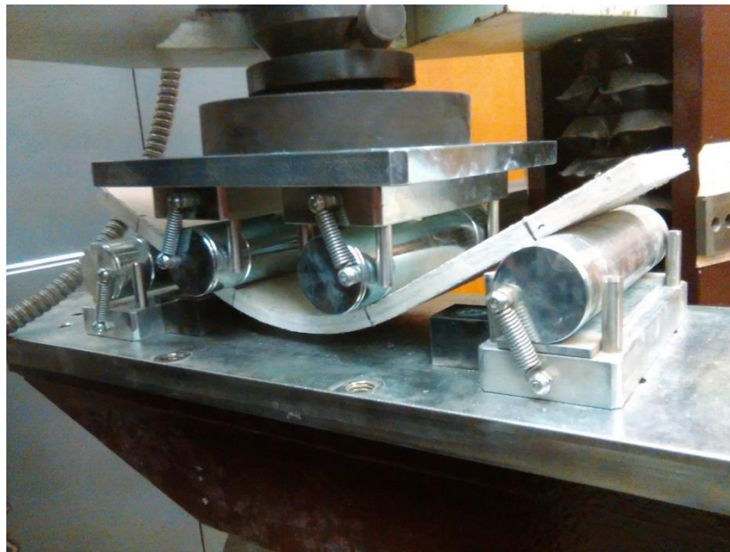
Obrázek 30 Maximální průhyb vzorku [27]
