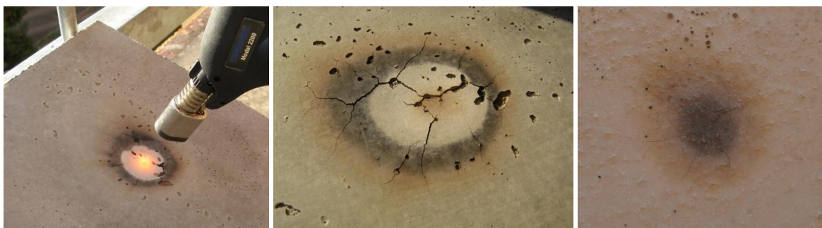
Obrázek 37 Zahřívání zkušebního tělesa teplotu 1200 °C
