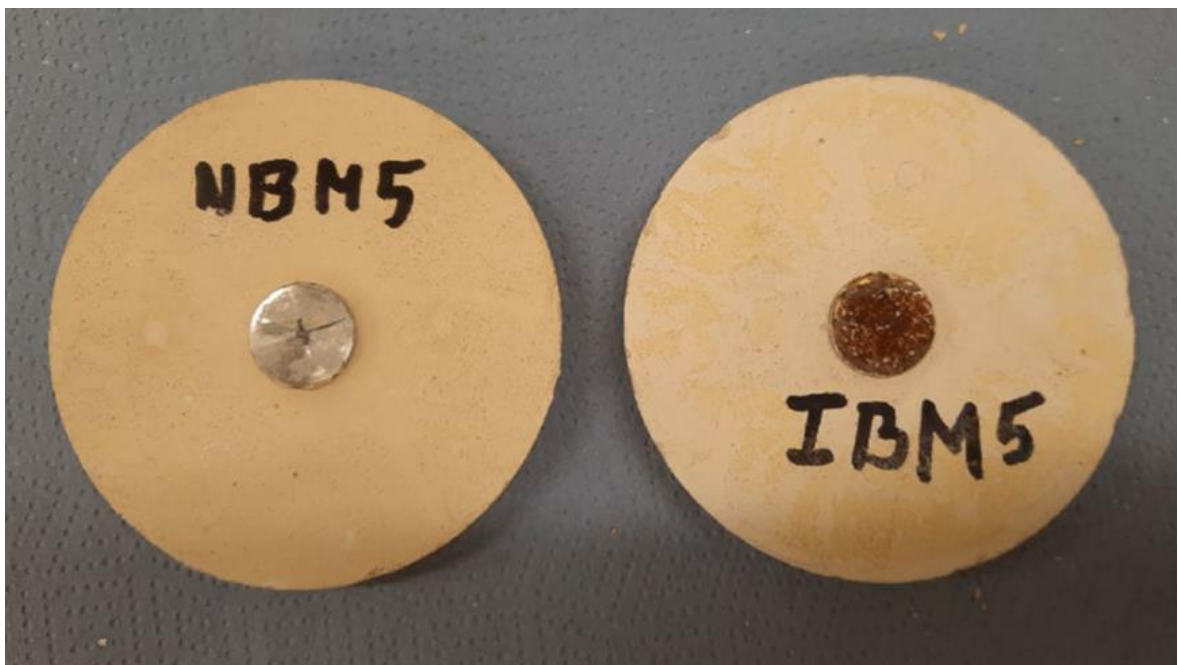
Obrázek 80 Koroze výztuže neozářeného (vlevo) a ozářeného vzorku
