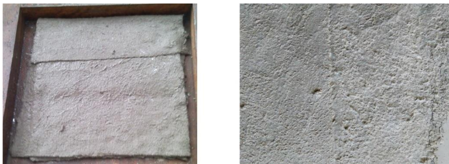
Obrázek 18 Vzorek z malty s kamenivem 0-0,25 mm [26]
