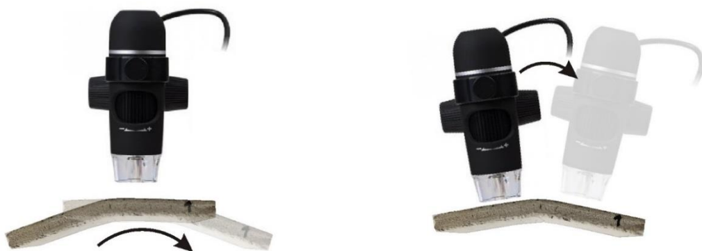
Obrázek 44 Vyhodnocování zakřiveného vzorku [44]
