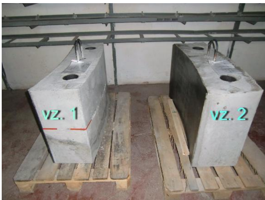
Obrázek 49 Vzorky biologického stínění vyrobené pro Ústav jaderného výzkumu v Řeži v roce 2013 [46]
