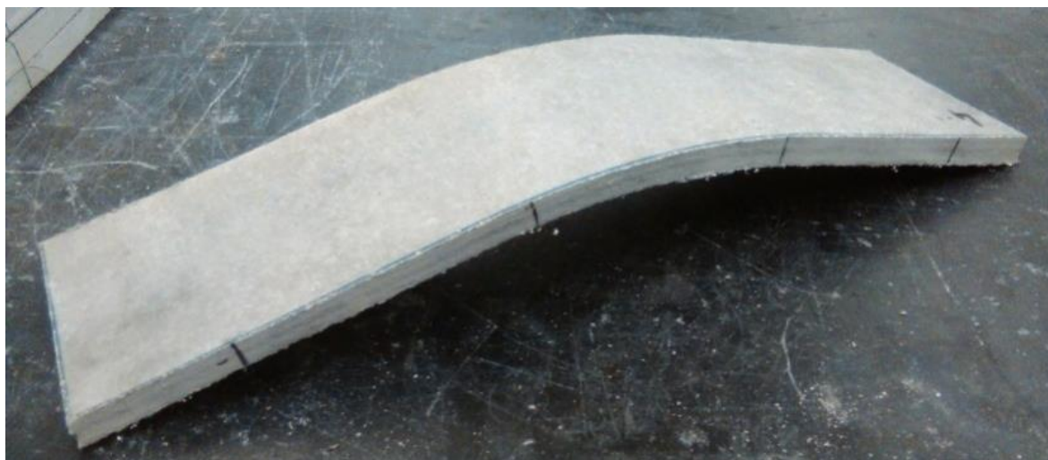
Obrázek 32 Nevratná deformace vzorku [28]
