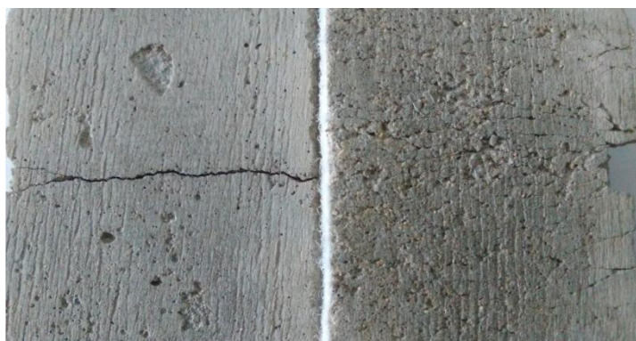
Obrázek 22 Trhliny v porušených vzorcích (vlevo: jednovrstvý, vpravo: dvouvrstvý) [26]
