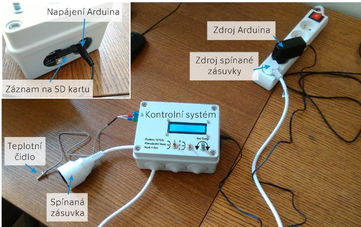
Obrázek 110 Zapojení kontrolního systému
