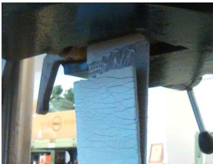
Obrázek 36 Delaminace dvouvrstvého vzorku se skelnou výztužnou tkaninou [28]
