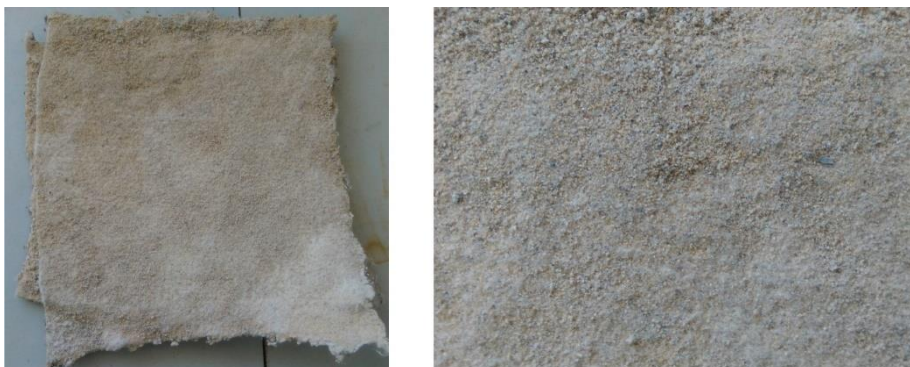
Obrázek 15 Vzorek z malty s kamenivem 0-0,5 mm [26]
