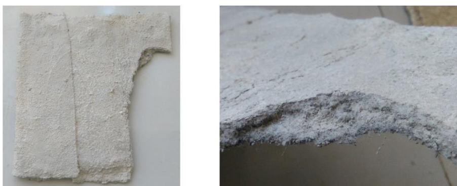
Obrázek 19 Soudržnost vrstev vzorku z malty s kamenivem 0-0,25 mm [26]
