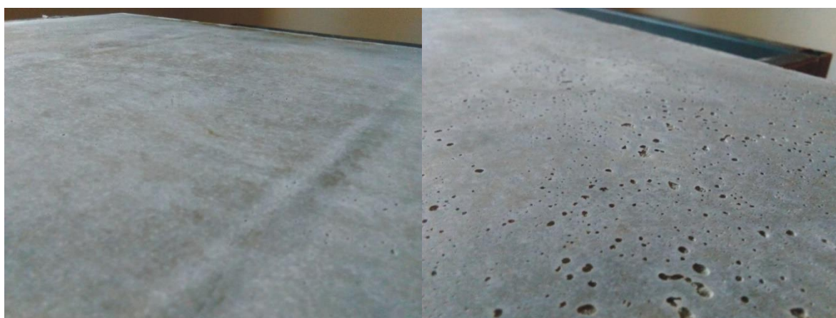
Obrázek 27 Spodní povrch vzorků (zleva: dobře zhutněný vzorek; nedostatečně zhutněný vzorek)
