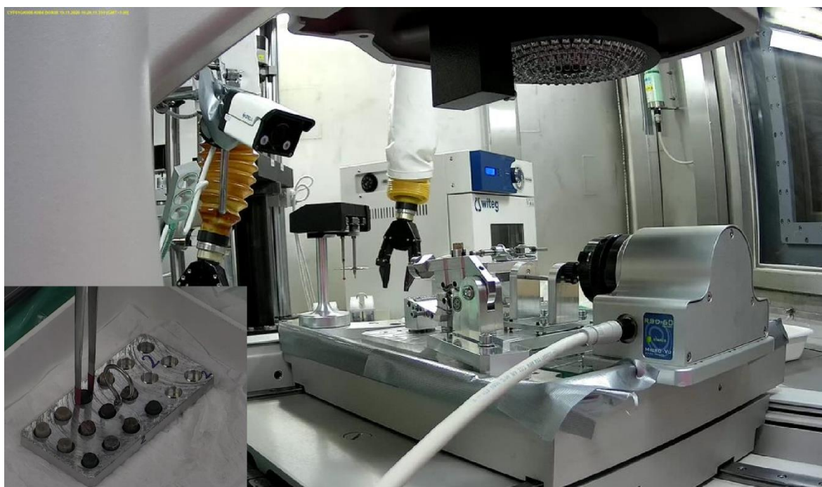
Obrázek 81 Horká komora (Foto: CV Řež)
