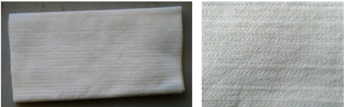
Obrázek 13 Geotextilie geoNETEX S 200g/m 2 [26]
