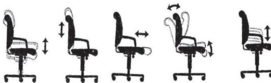
Obrázek 6 Nastavitelné parametry sedadla (Marek, 2009, s. 73)
