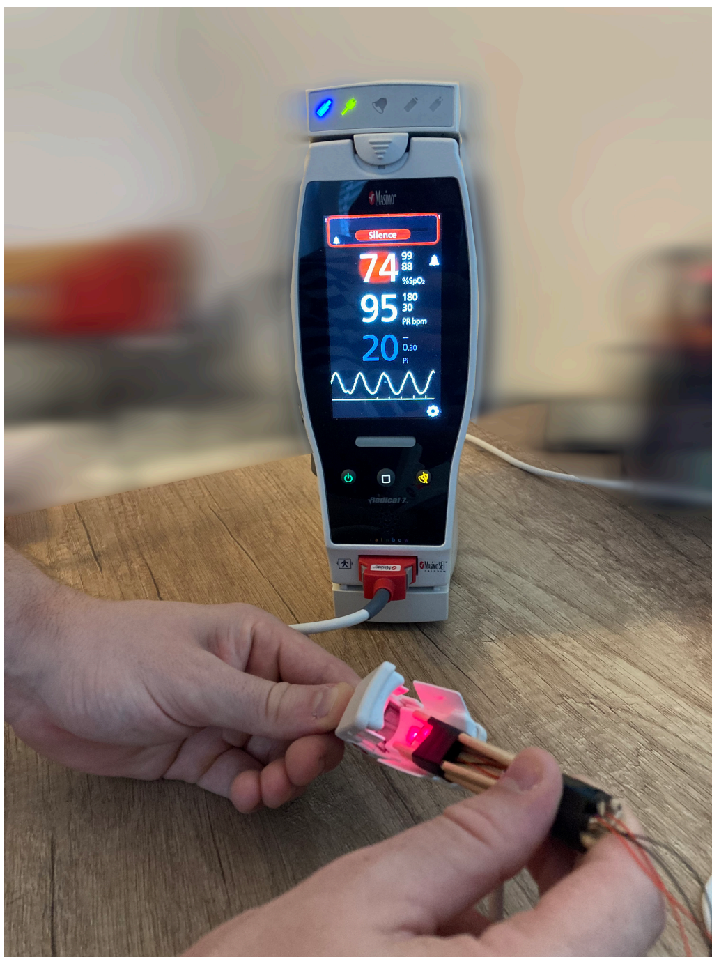
Obrázek 6.1: Projevení sinusového charakteru pletysmografické křivky při odhalení diody oxymetru.
