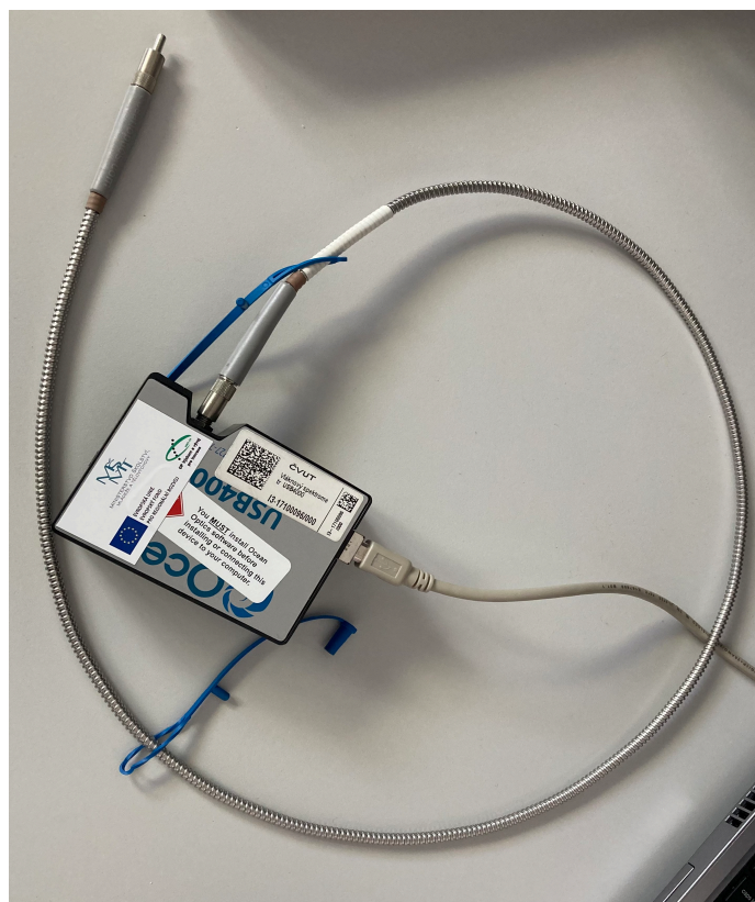
Obrázek 4.1: Vláknový spektrometr USB4000. (Ocean Insight) [27]
