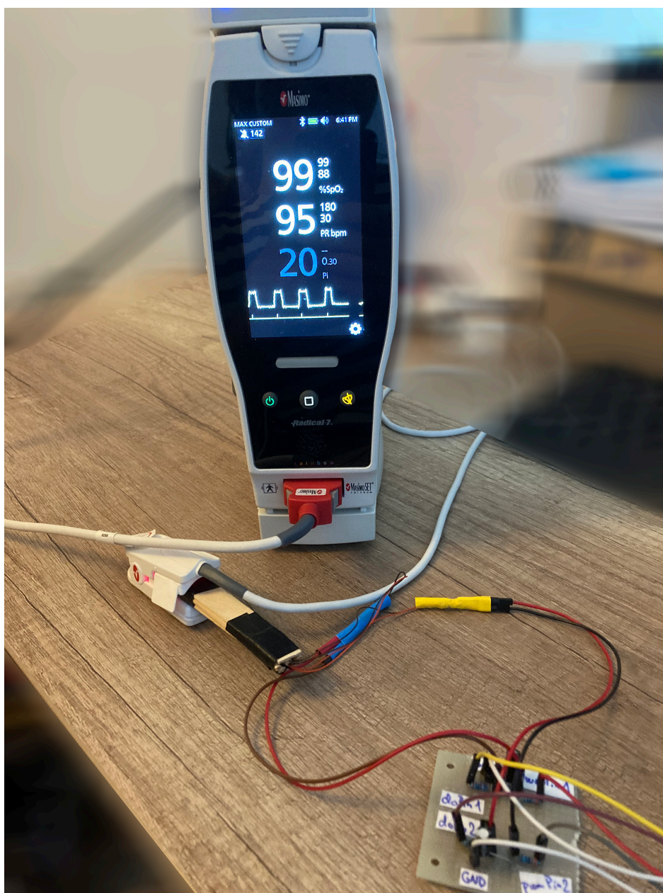
Obrázek 5.2: Ověření parametrů simulace pulzním oxymetrem Masimo Radical-7
