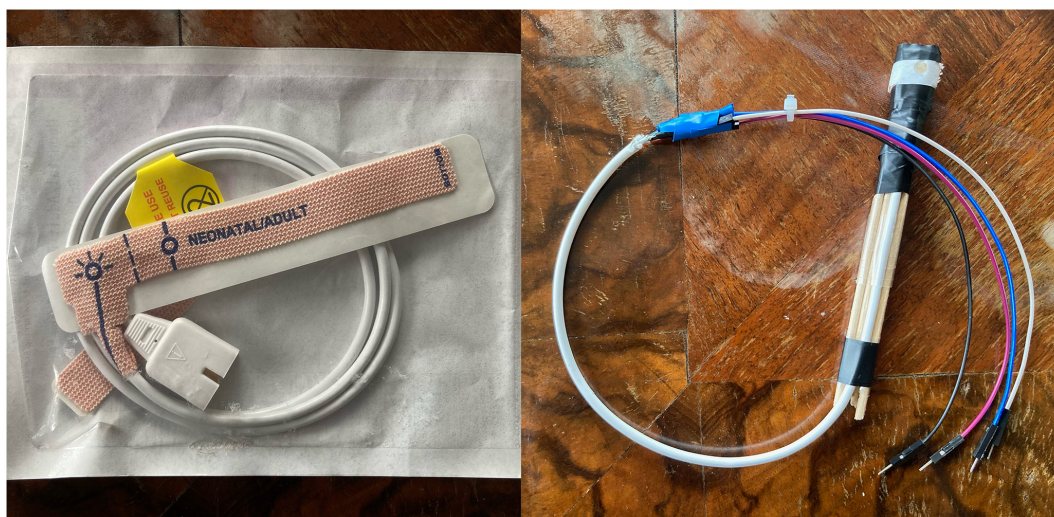
Obrázek 4.13: Jednorázový senzor MedLinket (vlevo) a testovací prototyp simulátoru (vpravo)
