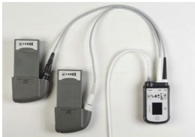
Obrázek 10 – Systémový ovladač připojený přes napájecí kabely k bateriovým svorkám [39]
