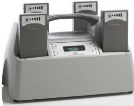
Obrázek 9 – Nabíječka baterií s vloženými bateriemi [39]
