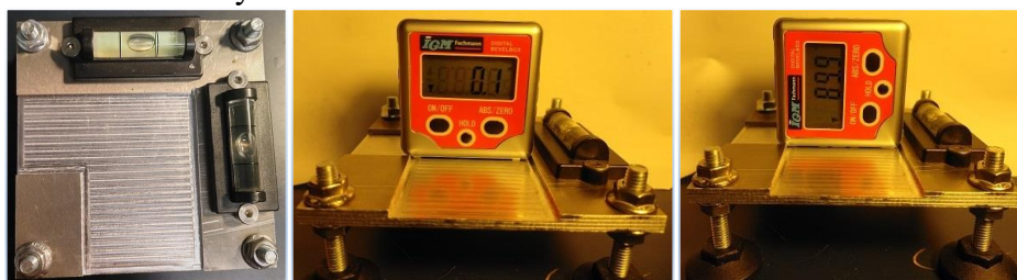
Obr. 8.1: Korektní vodorovná poloha podle vodováhy (vlevo), korektní vodorovná poloha podle digitálního úhlooměru (uprostřed) a korektní svislá poloha podle digitálního úhlooměru
