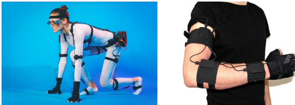
Obr. 2.9: Příklad inerciálního celotělového MoCap systému na celé tělo (vlevo) (převzato z [30]) a pouze na paži (vpravo) (převzato z [31])
