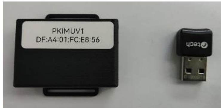
Obr. 5.8: senzor UMP-6050 v pouzdru (vlevo) a usb Bluetooth adaptér (vpravo)
