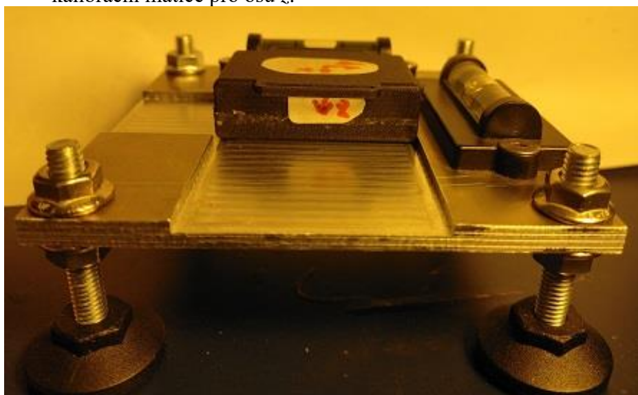
Obr. 8.12: Korektní umístění senzoru pro osu z v kolmém směru k zemi
