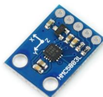
Obr. 2.8: Příklad MEMS magnetometru (převzato z [29] )
