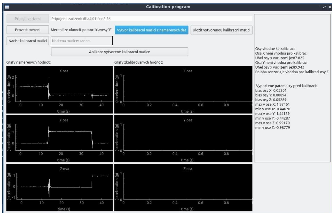
Obr. 8.14: Naměření alespoň pěti vteřin měření, po kterém následuje stisknutí tlačítka vytvoření kalibrační matice
