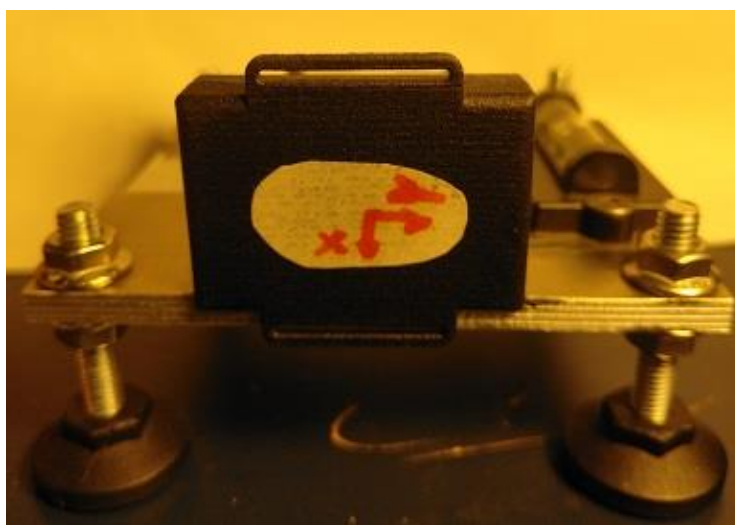
Obr. 5.20: Korektní umístění senzoru pro osu x v kolmém směru na zem
