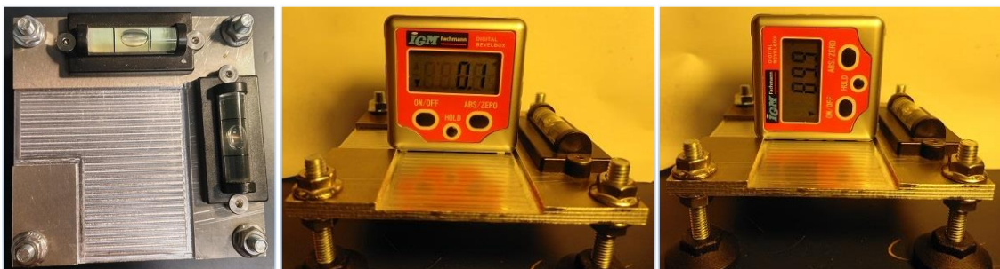
Obr. 5.19: Korektní vodorovná poloha podle vodováh (vlevo), korektní vodorovná poloha podle digitálního úhloměru (uprostřed) a korektní svislá poloha podle digitálního úhloměru
