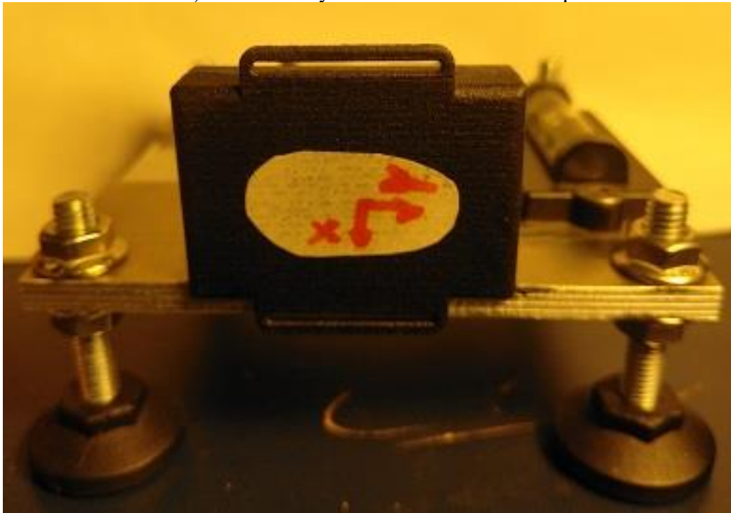
Obr. 8.6: Korektní umístění senzoru pro osu x v kolmém směru k zemi
