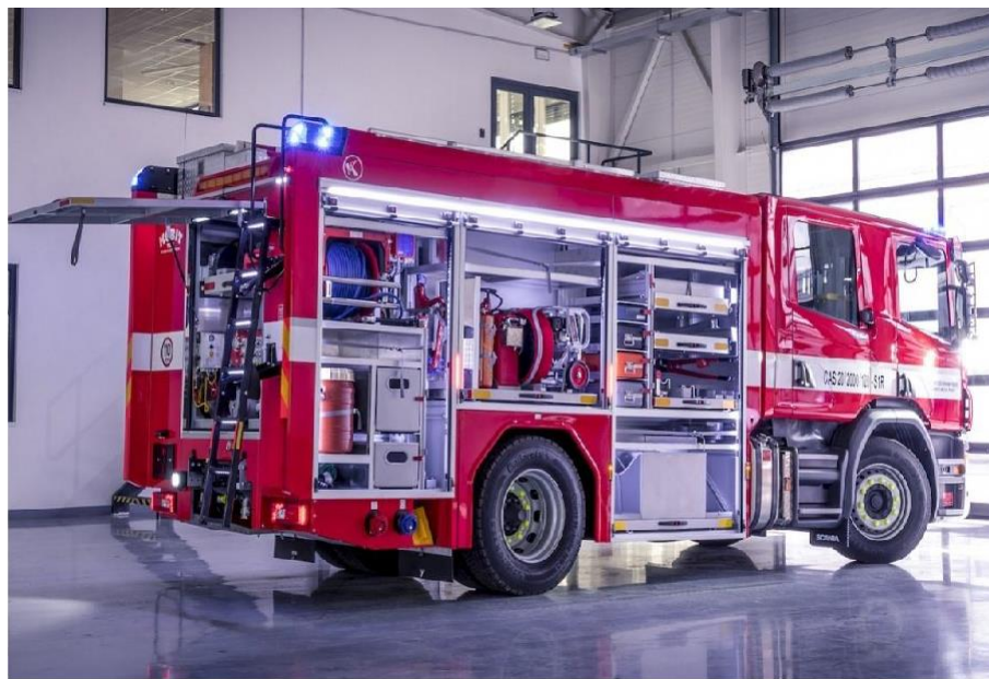
Obr. 4 - Cisternová automobilová stříkačka Scania – výbava [45]
