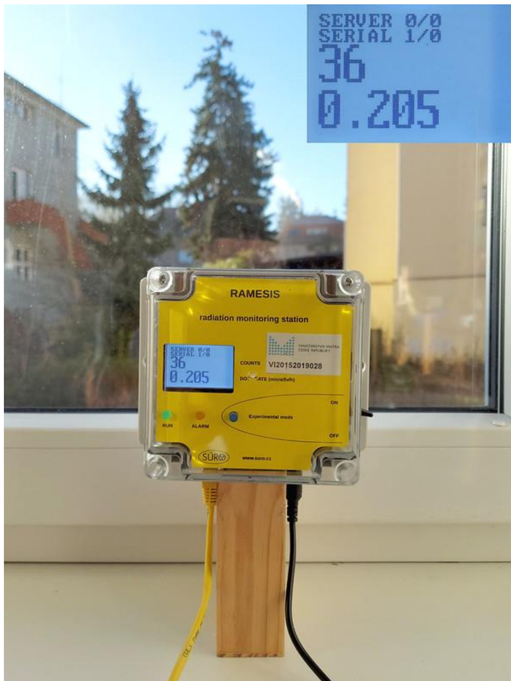
Obrázek 11 - Fixní stanička RAMESIS pro radiační monitoring (35)
