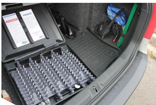
Obrázek 23 - zastavovací pás ROAD BLOCK v přepravní schránce [23]
