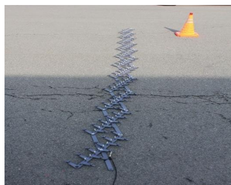
Obrázek 24 - zastavovací pás ROAD BLOCK roztažený [24]
