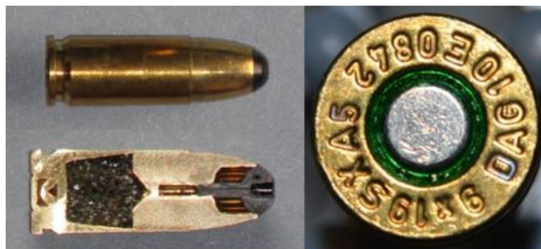
Obrázek 19 - Náboj Sintox ACTION 5 [19]
