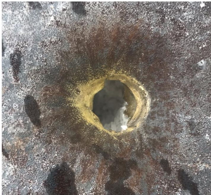
Obrázek 20 – Účinek střely na plášť tlakové láhve [vlastní zdroj]
