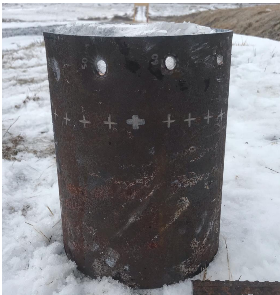
Obrázek 19 – Řez tl. láhve s vyznačeným záměrným bodem [vlastní zdroj]
