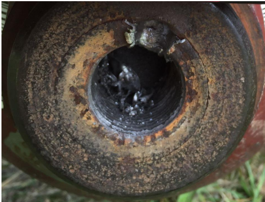
Obrázek 42 – Zásah hrdla tlakové láhve [vlastní zdroj]
