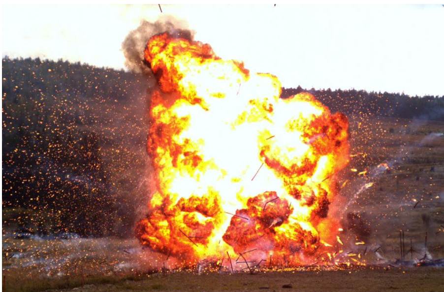
Obrázek 5 – Projev FIRE BALL po neřízené explozi acetylenové láhve [vlastní zdroj]
