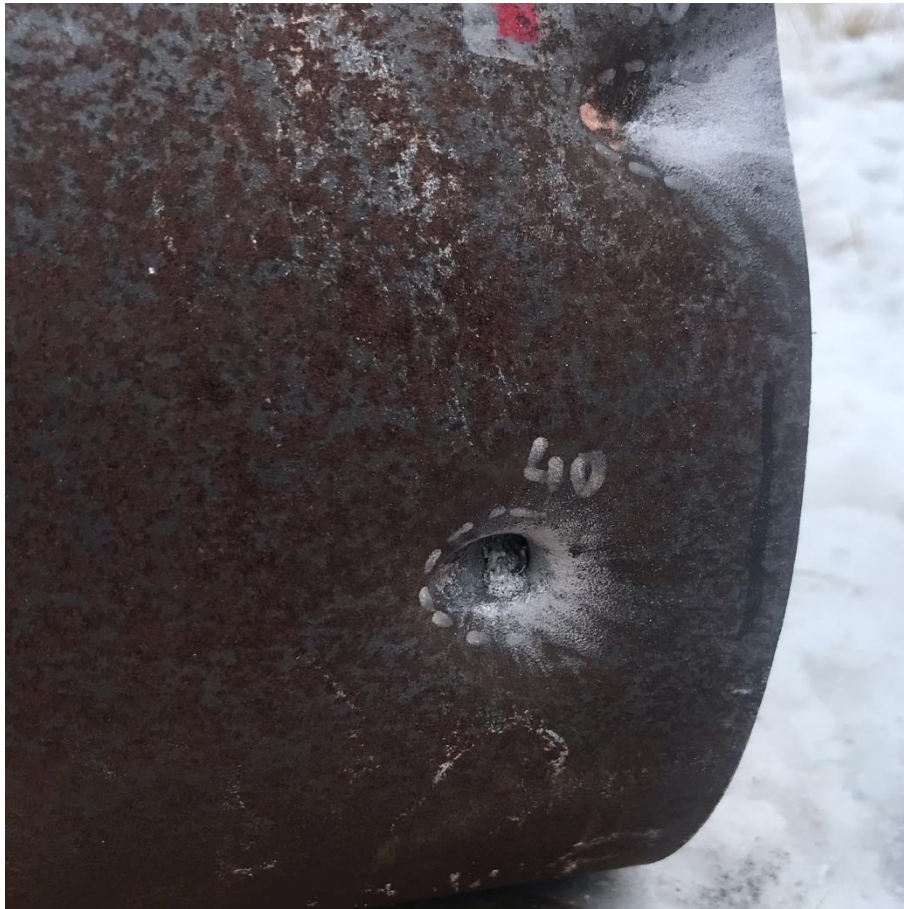
Obrázek 24 – Účinek střely na plášti láhve při náklonu 40° vůči střelci [vlastní zdroj]
