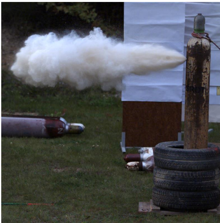
Obrázek 3 – Projev JET po penetraci pláště acetylenové tlakové láhve [vlastní zdroj]
