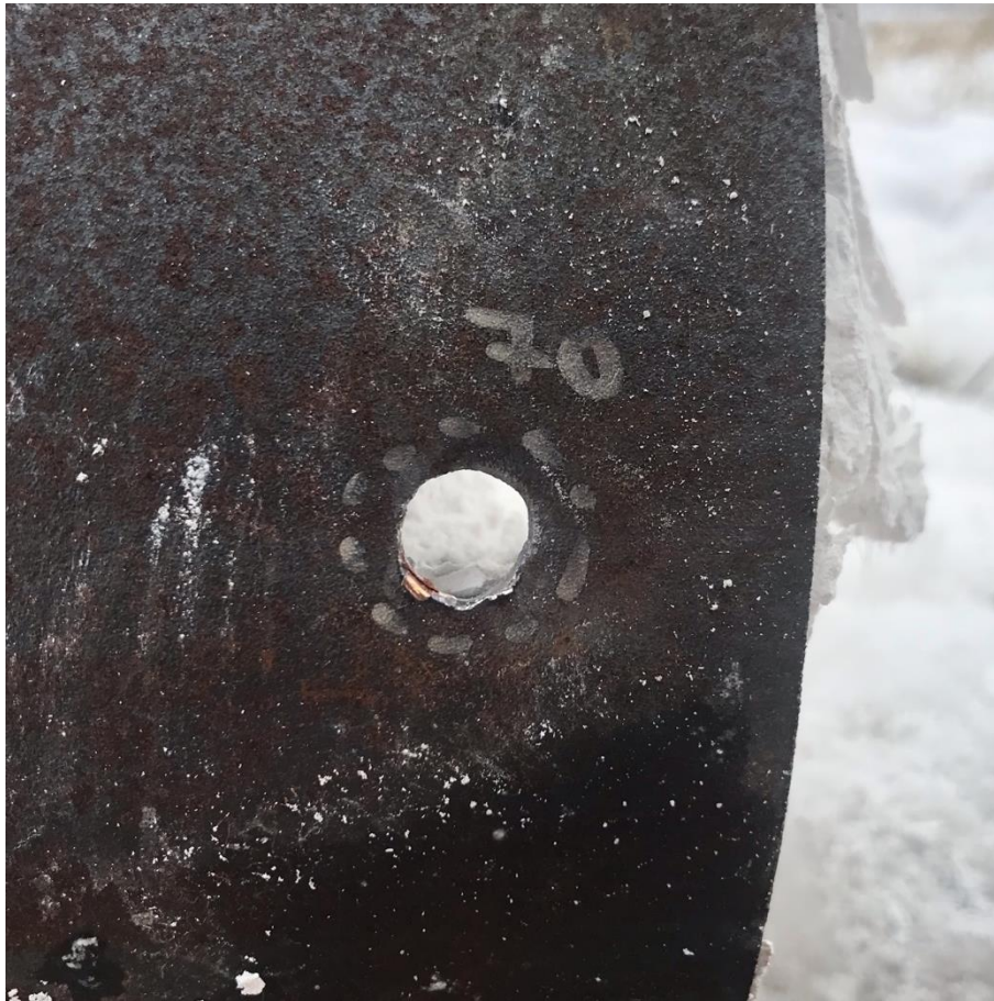
Obrázek 27 – Účinek střely na plášti láhve při náklonu 70° vůči střelci [vlastní zdroj]
