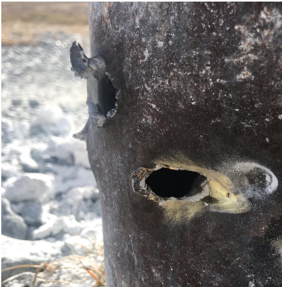
Obrázek 40 – Účinek střely na plášti láhve při náklonu 10° vůči střelci [vlastní zdroj]
