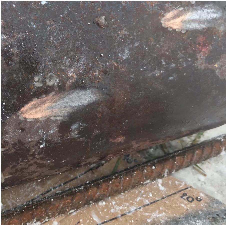
Obrázek 29 – Účinek střely na plášti láhve při náklonu 20° vůči střelci [vlastní zdroj]
