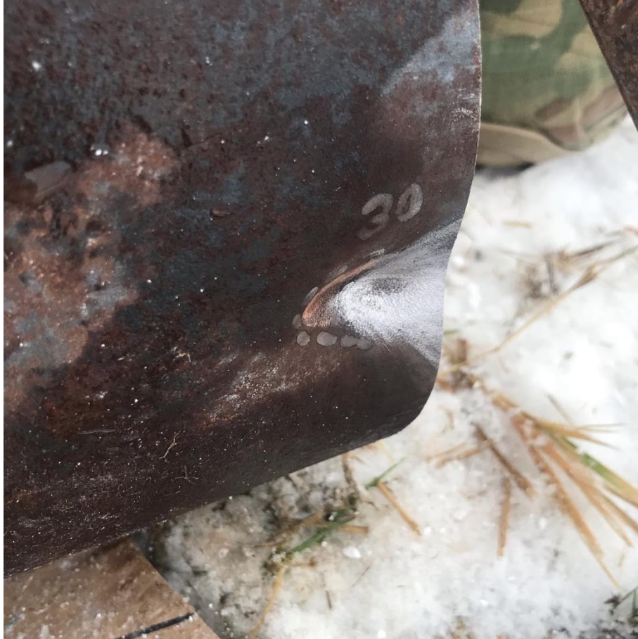
Obrázek 30 – Účinek střely na plášti láhve při náklonu 30° vůči střelci [vlastní zdroj]
