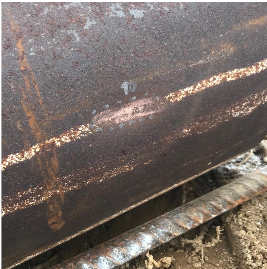
Obrázek 34 – Účinek střely na plášti láhve při náklonu 10° vůči střelci [vlastní zdroj]
