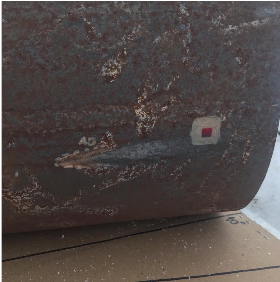
Obrázek 21 – Účinek střely na plášti láhve při náklonu 10° vůči střelci [vlastní zdroj]
