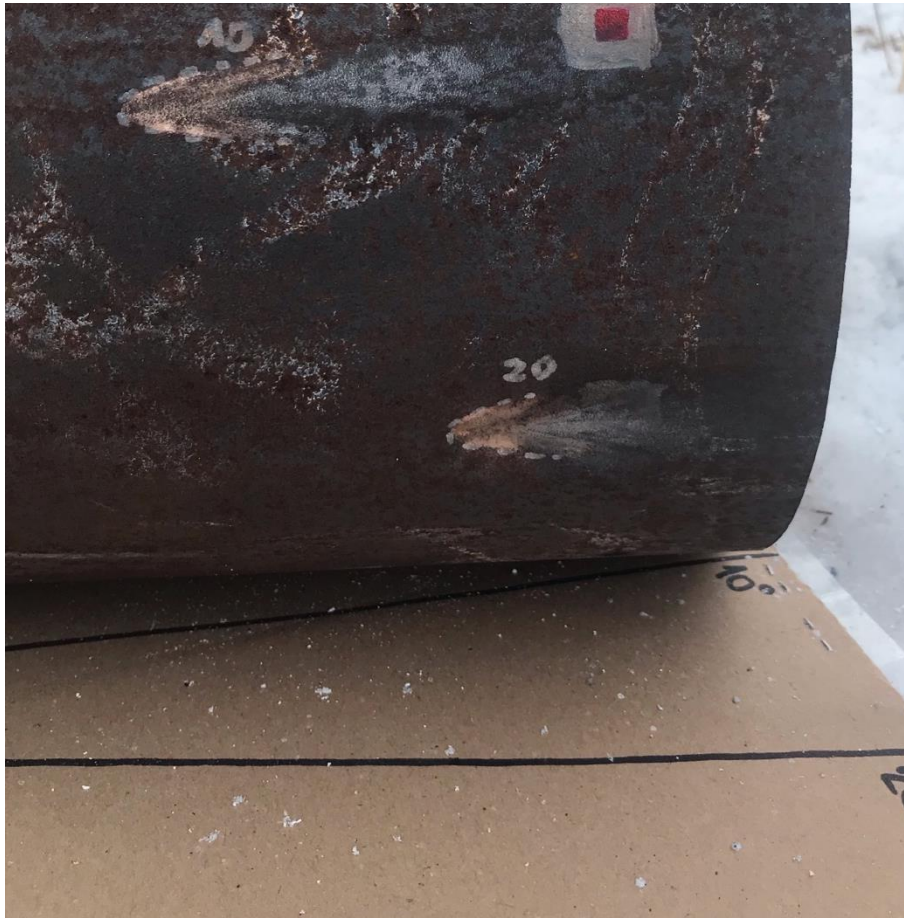
Obrázek 22 – Účinek střely na plášti láhve při náklonu 20° vůči střelci [vlastní zdroj]
