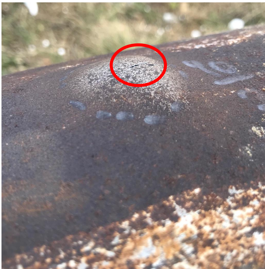
Obrázek 39 – Účinek střely na plášti láhve při náklonu 90° vůči střelci [vlastní zdroj]
