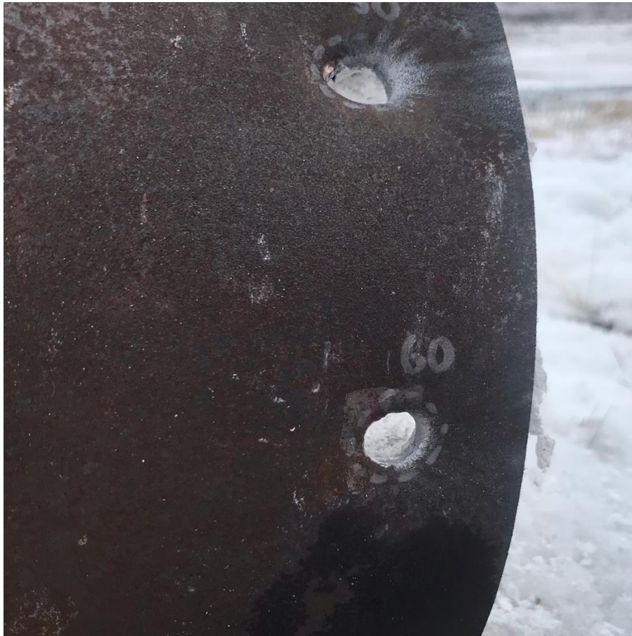
Obrázek 26 – Účinek střely na plášti láhve při náklonu 60° vůči střelci [vlastní zdroj]
