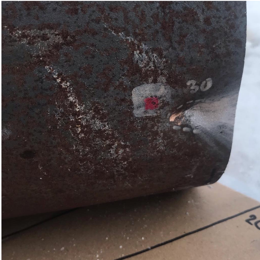
Obrázek 23 – Účinek střely na plášti láhve při náklonu 30° vůči střelci [vlastní zdroj]
