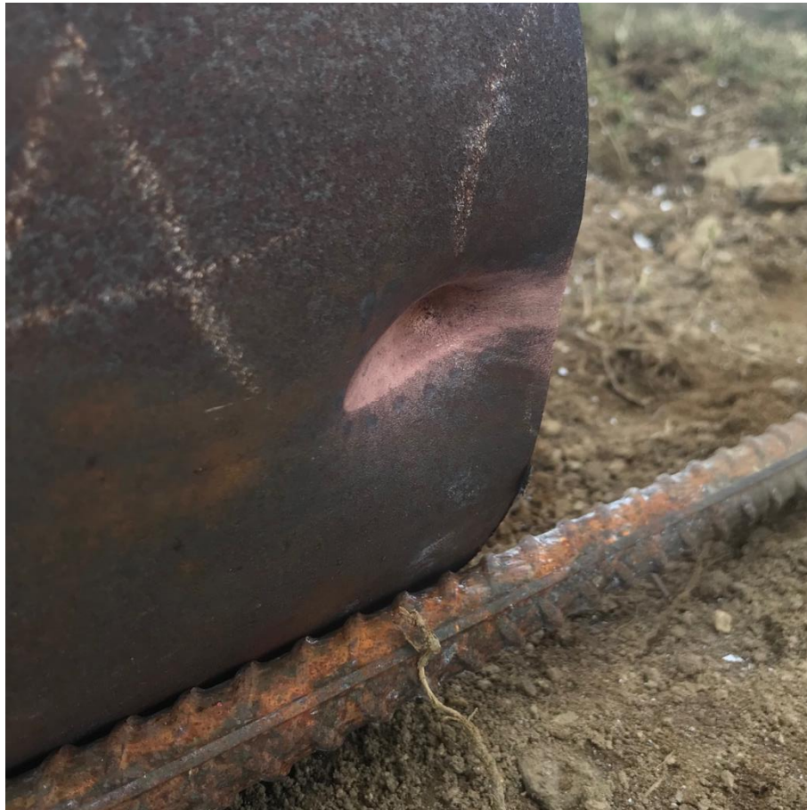
Obrázek 36 – Účinek střely na plášti láhve při náklonu 30° vůči střelci [vlastní zdroj]
