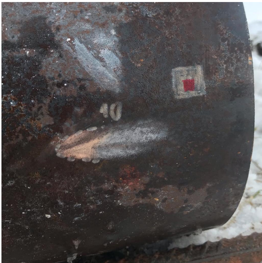
Obrázek 28 – Účinek střely na plášti láhve při náklonu 10° vůči střelci [vlastní zdroj]
