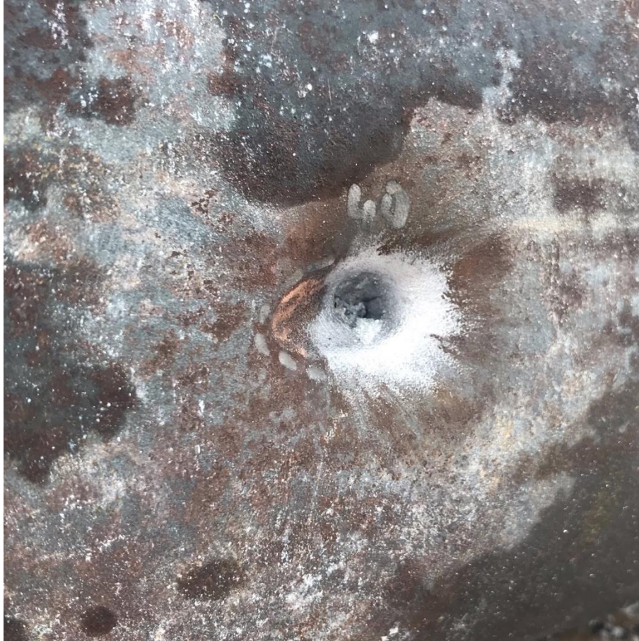
Obrázek 31 – Účinek střely na plášti láhve při náklonu 40° vůči střelci [vlastní zdroj]
