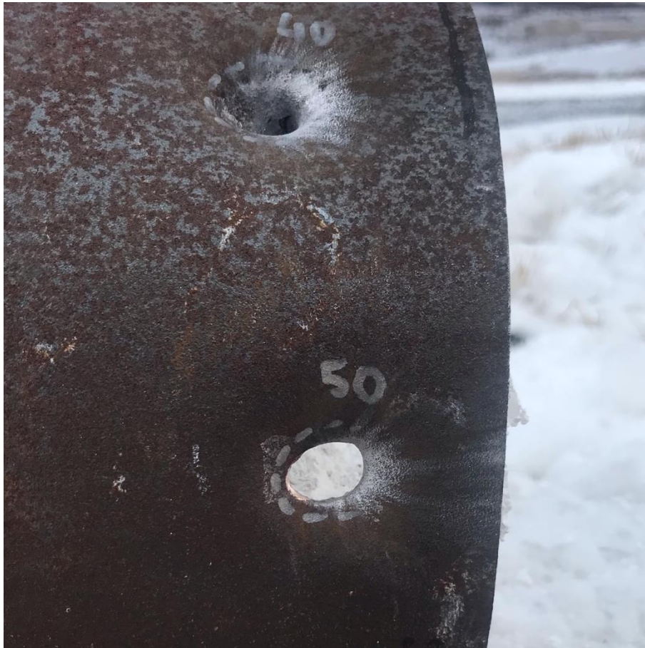
Obrázek 25 – Účinek střely na plášti láhve při náklonu 50° vůči střelci [vlastní zdroj]
