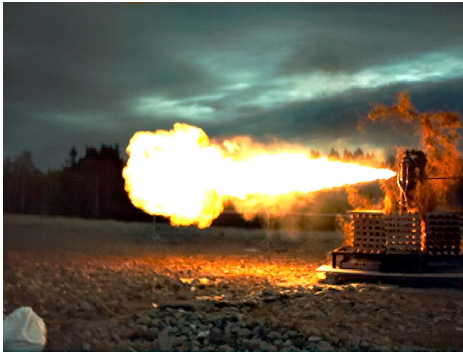
Obrázek 4 – Projev JET FIRE po penetraci pláště acetylenové tlakové láhve [vlastní zdroj]
