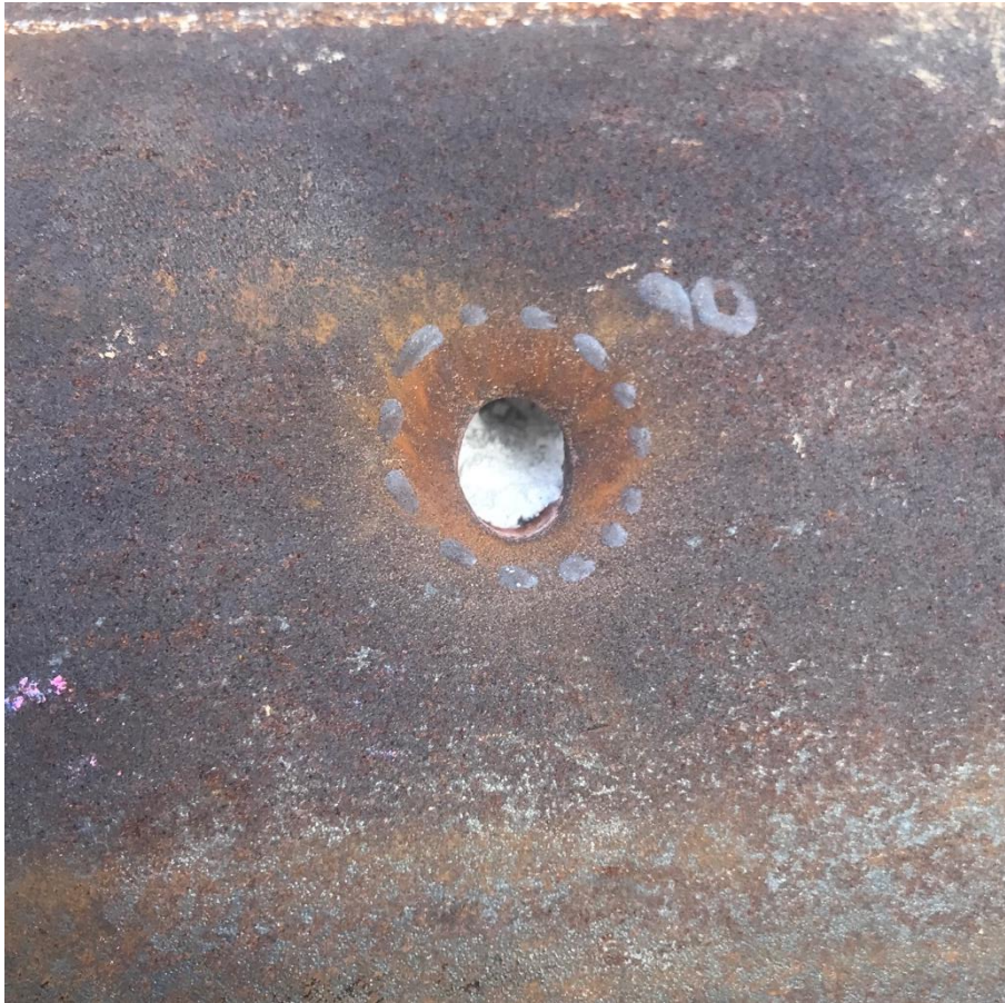
Obrázek 38 – Účinek střely na plášti láhve při náklonu 90° vůči střelci [vlastní zdroj]
