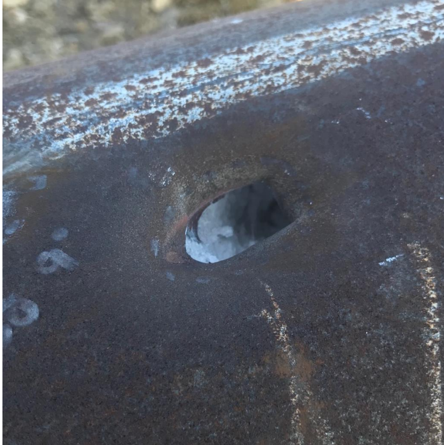
Obrázek 37 – Účinek střely na plášti láhve při náklonu 40° vůči střelci [vlastní zdroj]
