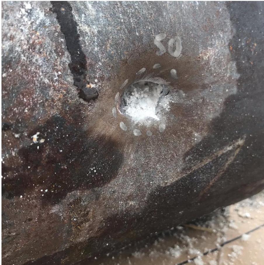
Obrázek 32 – Účinek střely na plášti láhve při náklonu 50° vůči střelci [vlastní zdroj]
