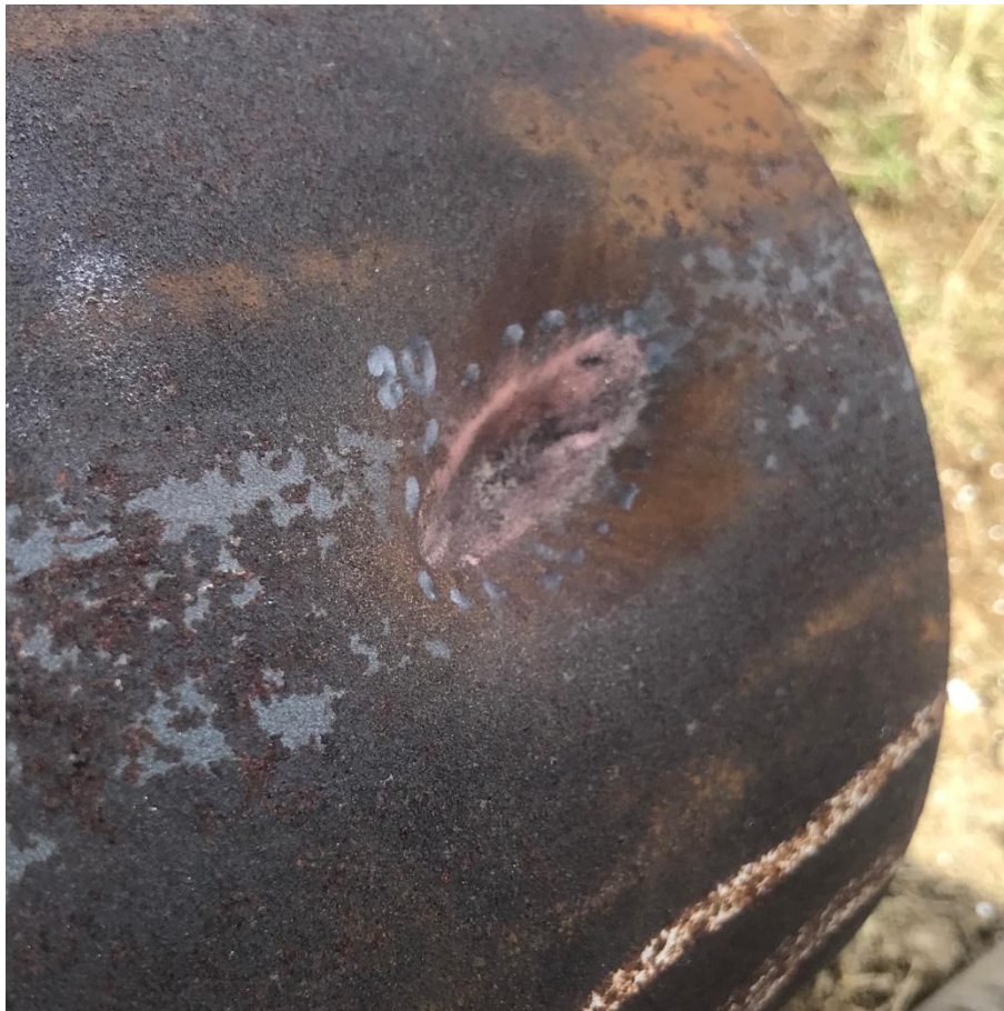
Obrázek 35 – Účinek střely na plášti láhve při náklonu 20° vůči střelci [vlastní zdroj]
