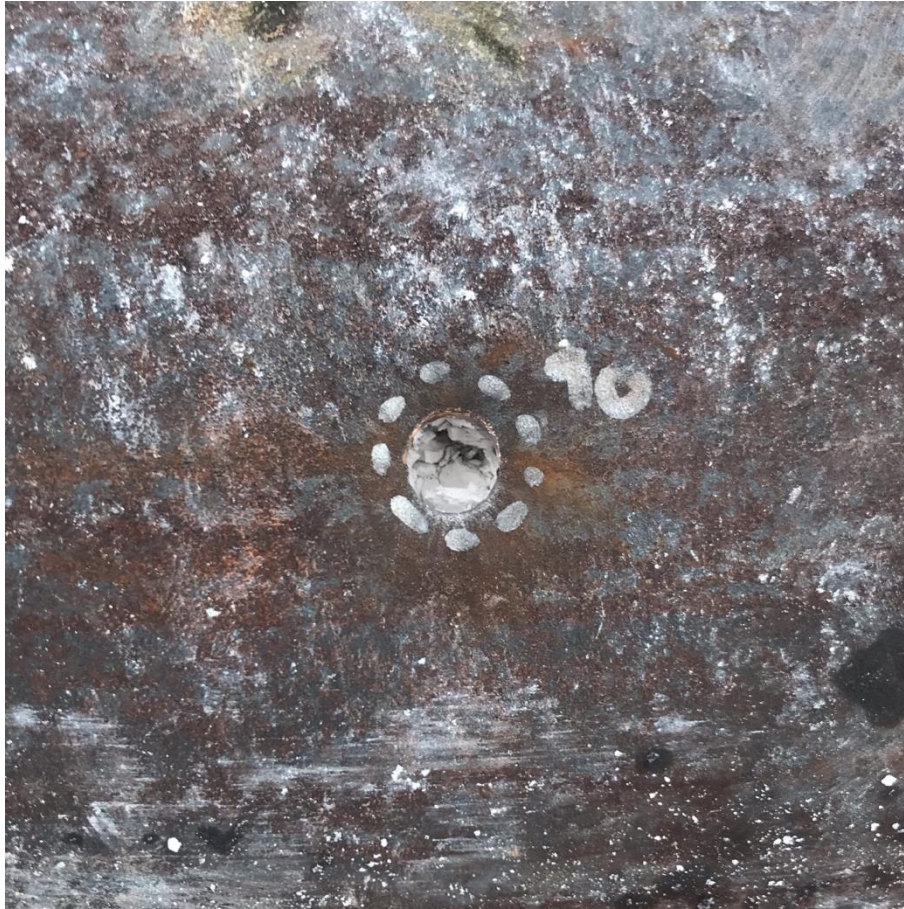
Obrázek 33 – Účinek střely na plášti láhve při náklonu 90° vůči střelci [vlastní zdroj]
