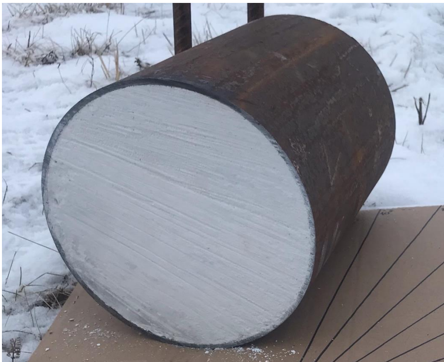
Obrázek 15 – Řez 50 l acetylenové tlakové láhve včetně porézní hmoty UL 1 [vlastní zdroj]
